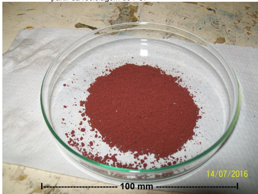
Figura 4.12 – Pó de cobre eletrolítico obtido a partir da reciclagem de PCI
