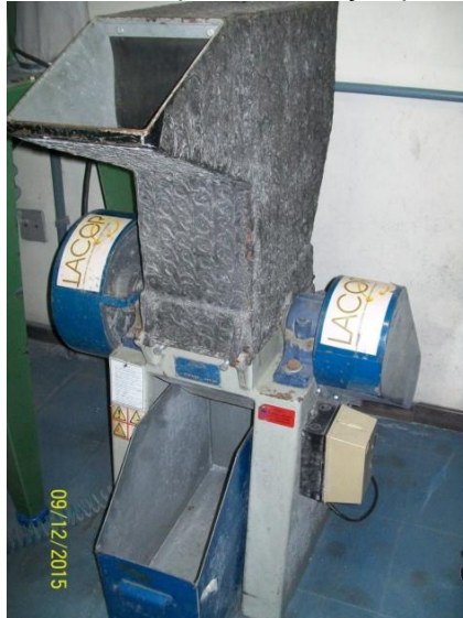
Figura 3.5 – Moinho de facas para cominuição primária, marca Rone
