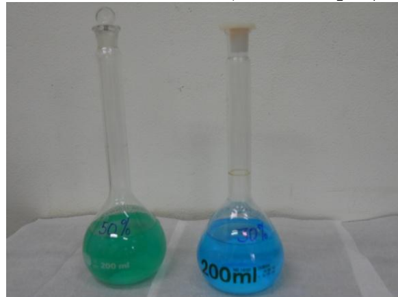
Figura 4.11 – Solução proveniente da lixiviação ácida em meio oxidante, 50 e 30% H 2 SO 4
