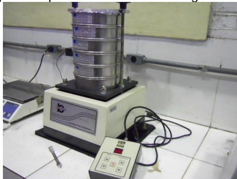
Figura 3.8 – Conjunto de peneiras montadas em agitador eletromecânico
