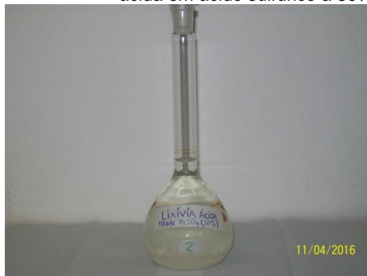
Figura 4.10 – Solução proveniente da lixiviação ácida em ácido sulfúrico a 30%
