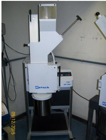
Figura 3.6 – Moinho de facas para cominuição secundária, marca Retsch
