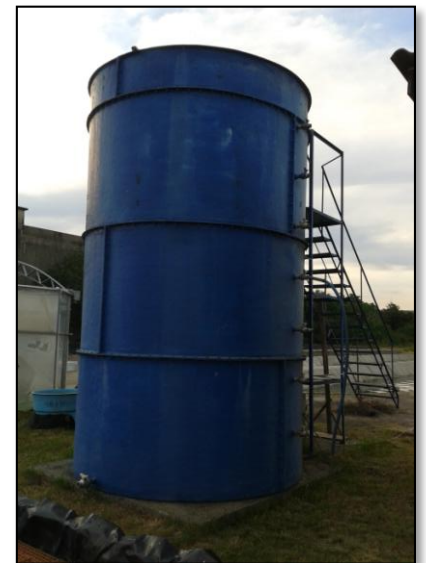
Figura 5.4 Fotos e desenho dimensional em metros do reator piloto UASB usado no experimento
