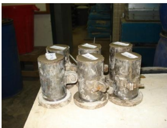
Figura 11: Moldes com argamassas feitas com CCA
