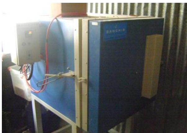
Figura 8: Forno elétrico utilizado para obtenção da CCA
