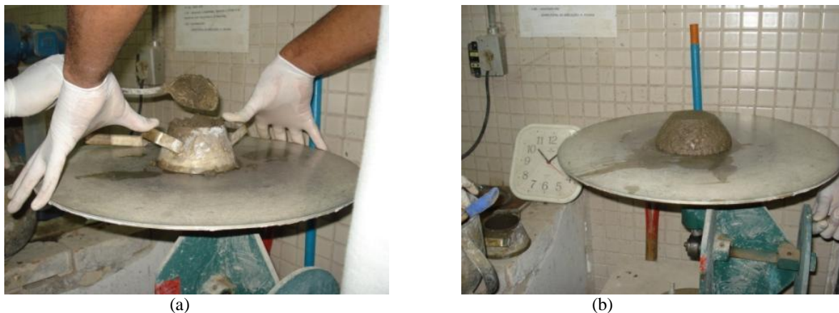
Figura 10: Ensaio de consistência (a) preenchimento do molde com argamassa e (b) argamassa pronta para ser submetida ao ensaio
