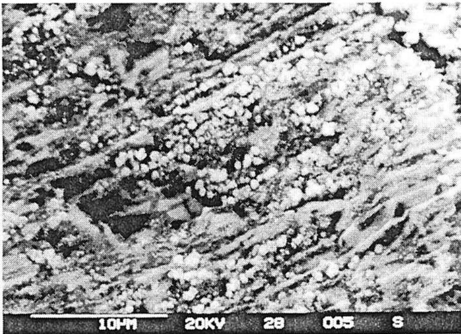
Figure III.3.5 : Electrode de zinc soumise à une polarisation anodique de  $20 \text{ mA.cm}^{-2}$ .
