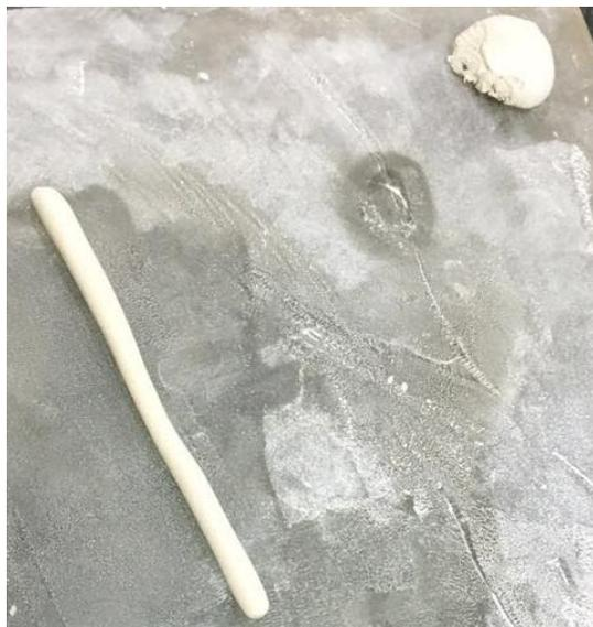
Figura 3.6 – Ensaio de limite de plasticidade em *chalk*
