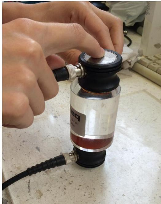
Figura 3.39 – Calibração do equipamento para ondas de cisalhamento
