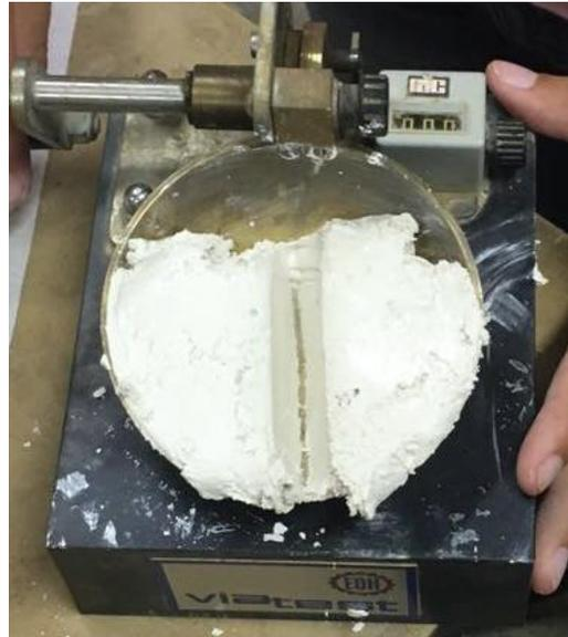
Figura 3.5 – Ensaio de limite de liquidez em *chalk*
