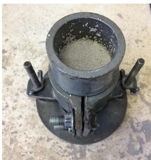
Figura 3.15 – Molde 50 x 100 mm utilizado na UFRGS
