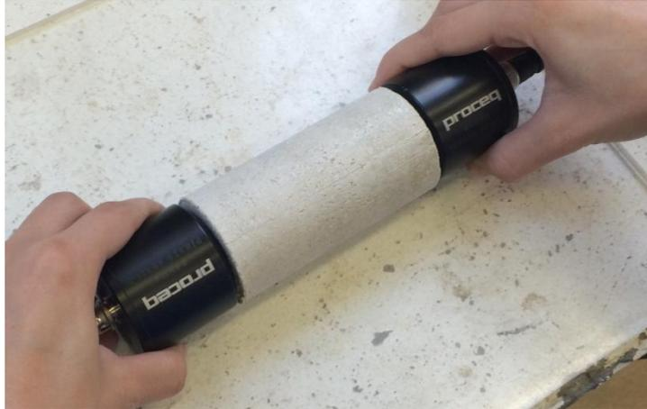
Figura 3.38 – Medição de onda p em corpos-de-prova de 50 x 100 mm
