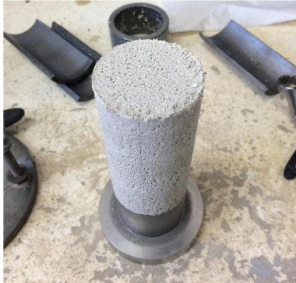
Figura 3.20 – Desmoldagem do corpo-de-prova com molde metálico - UFRGS
