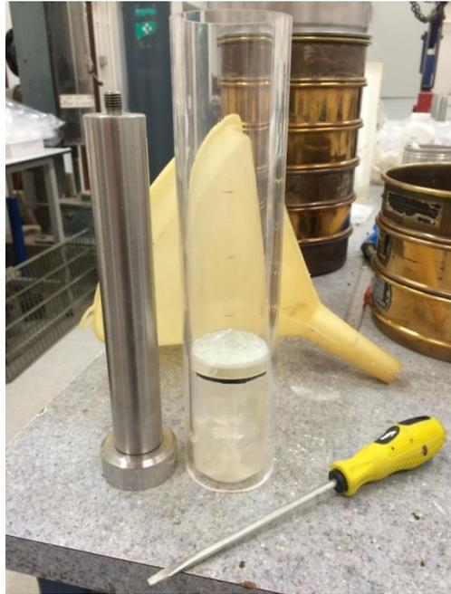
Figura 3.16 – Molde 50 x 100 mm utilizado na UoB
