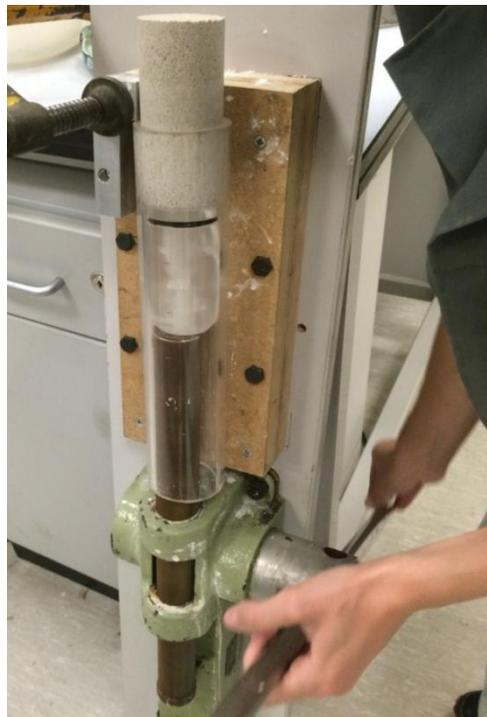
Figura 3.21 – Desmoldagem do corpo-de-prova com molde acrílico – UoB
