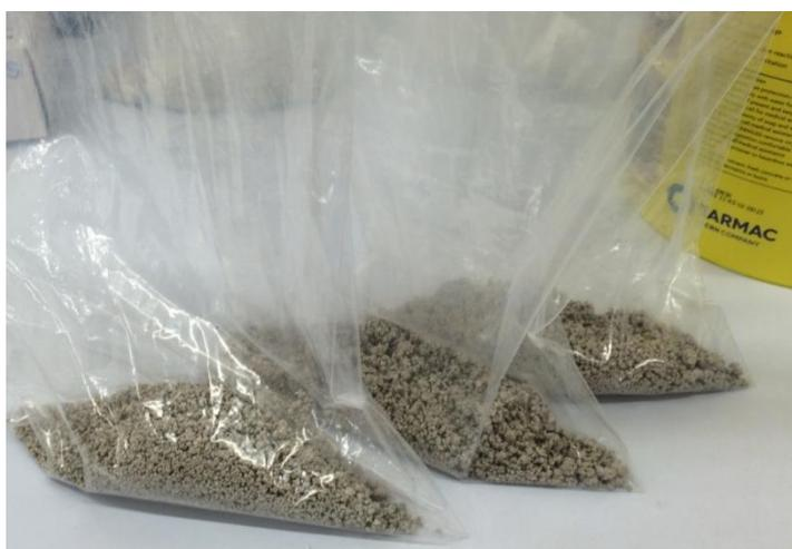
Figura 3.13 – Material pesado e separado em sacos para cada camada a ser compactada
