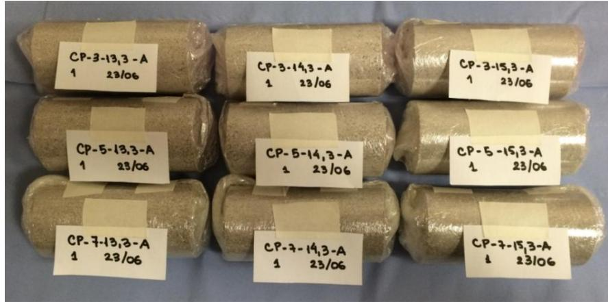
Figura 3.22 – Corpos identificados e envolvidos com plástico filme para que não houvesse perda de umidade – UoB
