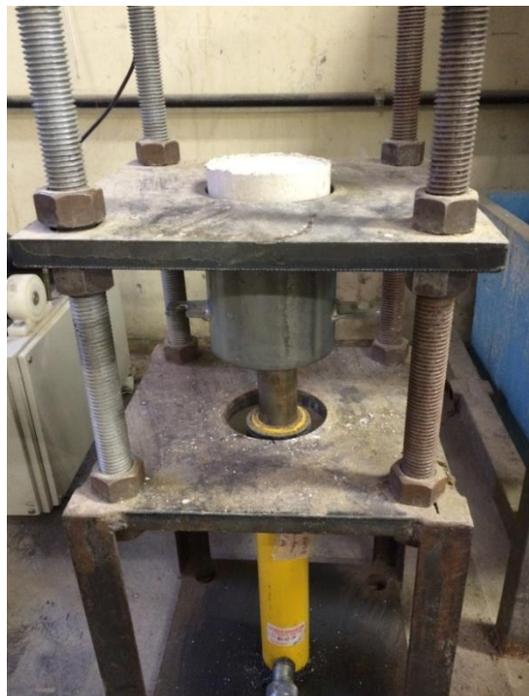
Figura 3.31 – Extrusor utilizado no ensaio de durabilidade
