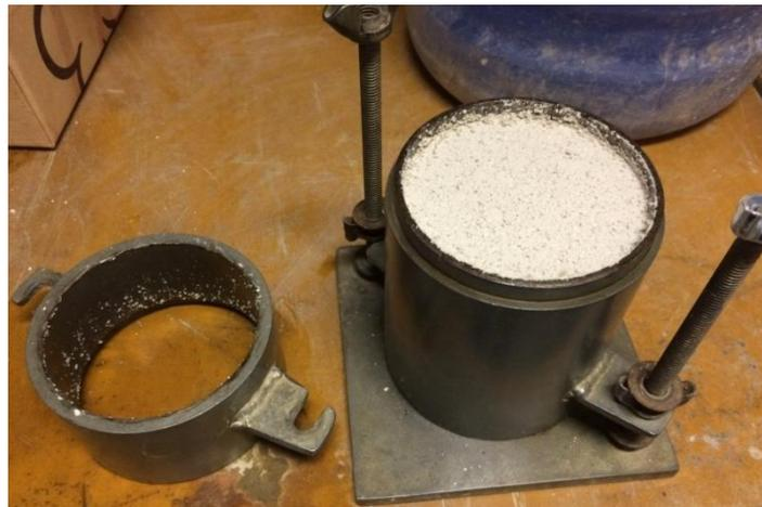
Figura 3.30 – Molde utilizado para ensaios de durabilidade
