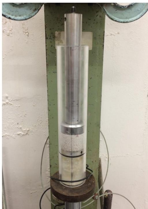
Figura 3.44 – Compactação das camadas intermediárias na prensa com *benders*
