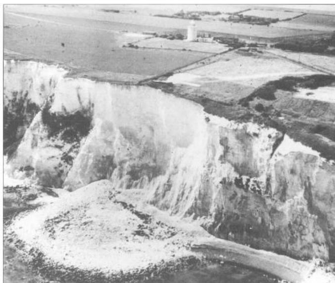
Figura 1.2 – Vista de deslizamento de *chalk* em Kent, 1958 (HUTCHINSON, 2002)
