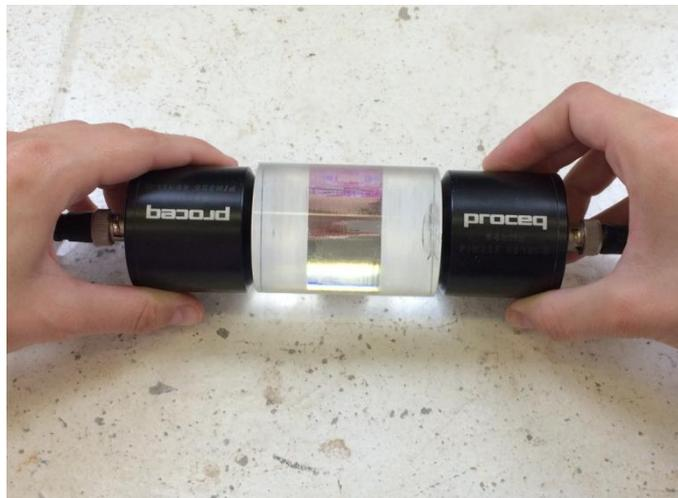
Figura 3.37 – Calibração do equipamento para ondas de compressão
