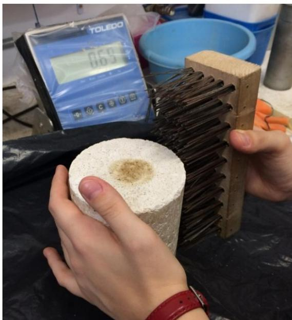
Figura 3.33 – Escovação das laterais do corpo-de-prova
