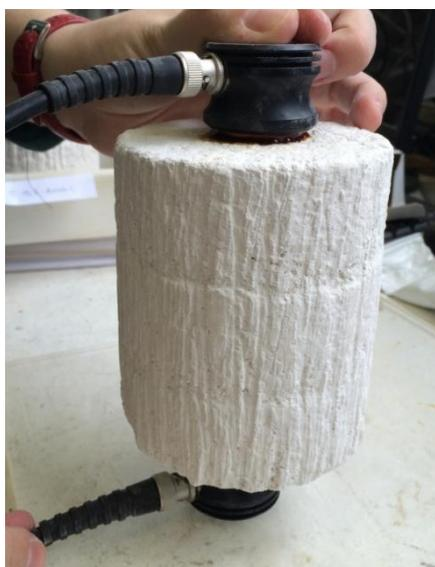
Figura 3.41 – Medição e aquisição de dados de ondas em corpos-de-prova de durabilidade
