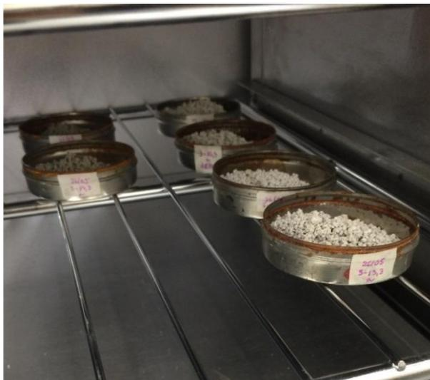
Figura 3.14 – Cápsulas para controle de umidade das misturas na estufa
