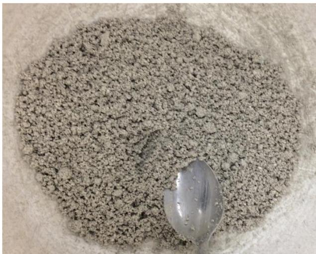
Figura 3.12 – Mistura homogênea obtida
