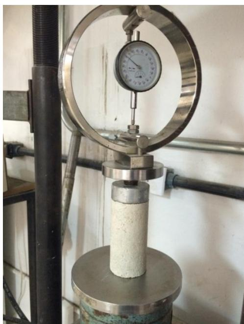
Figura 3.24 – Prensa utilizada nos ensaios de resistência à compressão simples – UFRGS
