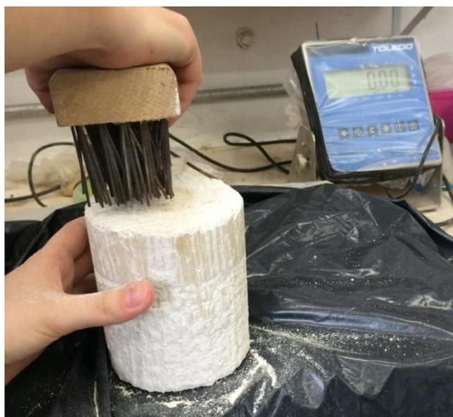
Figura 3.34 – Escovação do topo do corpo-de-prova
