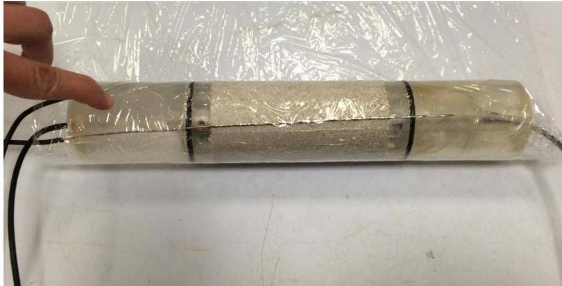
Figura 3.46 – Envolvimento do corpo-de-prova em plástico filme para reter umidade
