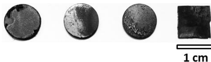
Figura 21: Deposição defeituosa de alguns filmes vistos a olho nu.
