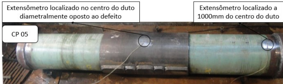
Figura 38: Extensômetros instalados nos corpos de prova CP04 e CP05 após a aplicação do reparo para realização do ensaio de fadiga
