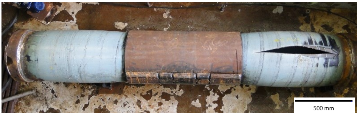
Figura 60: Corpo de prova 04 após ensaio hidrostático, apresentando rompimento fora da região de aplicação do reparo
