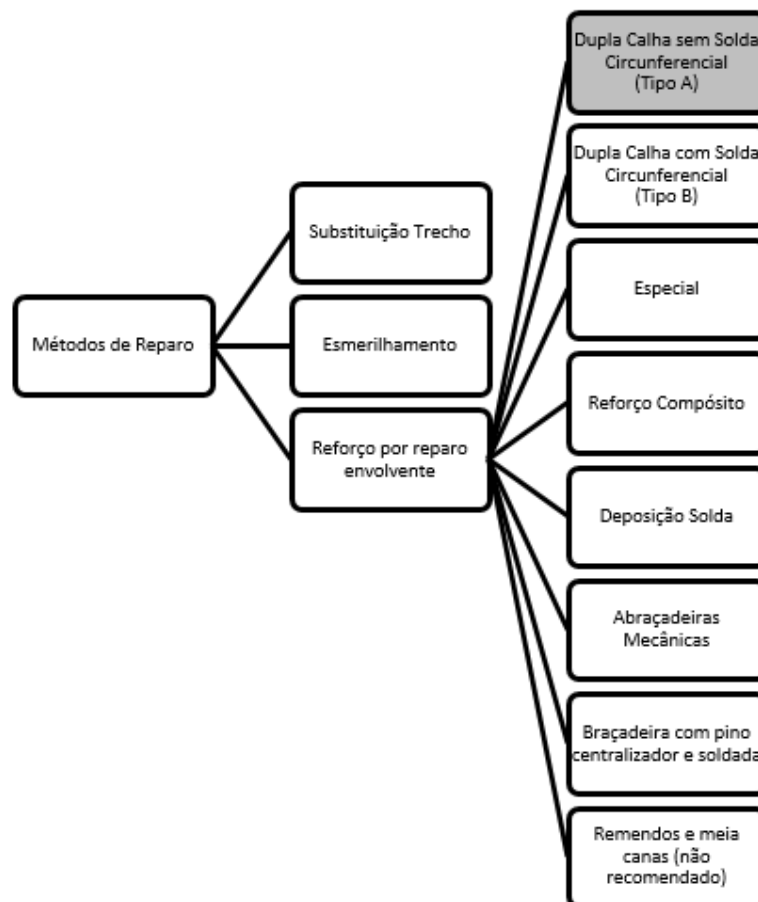
Figura 9: Resumo dos reparos
