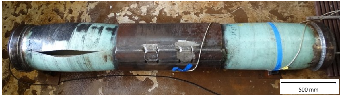
Figura 61: Corpo de prova 05 após ensaio hidrostático, apresentando rompimento fora da região de aplicação do reparo
