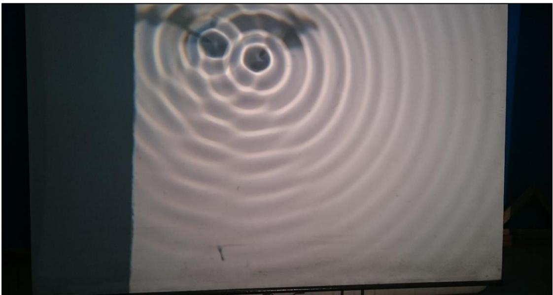
Figura 5.1: interferência de ondas, produzida em uma cuba d'água posicionada sobre um retroprojektor. FONTE: o autor.
