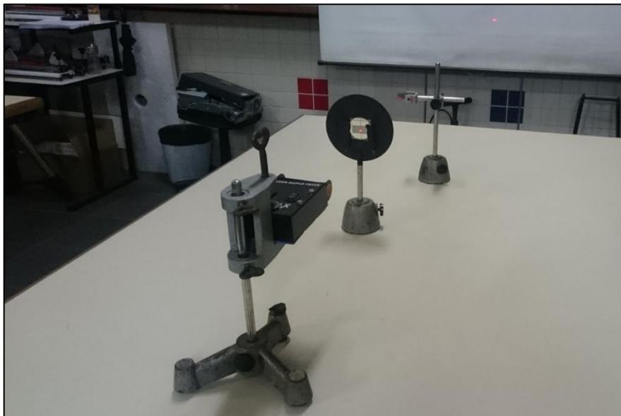
Figura 5.2: montagem experimental da borracha quântica. FONTE: o autor.
