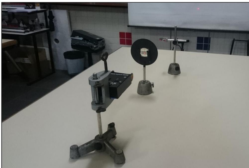
Figura 40: montagem experimental da borracha quântica. FONTE: o autor.
