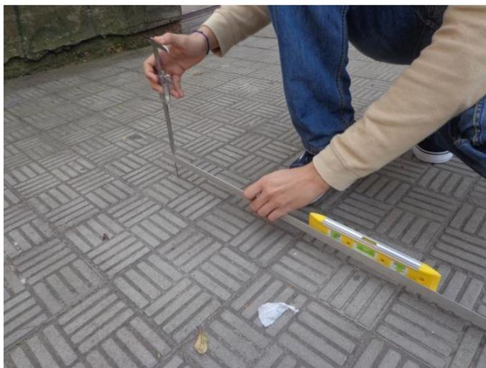
A verificação de acúmulo de água pode ser feita em dias de chuva, ou, por praticidade, através da constatação de manchas escuras de umidade e/ou pontos de inclinação convergente do piso.
