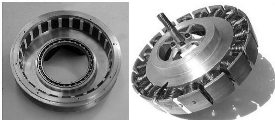
**Figura 27** – Rotor (esquerda) e estator (direita) de um motor de bicicleta [5].
