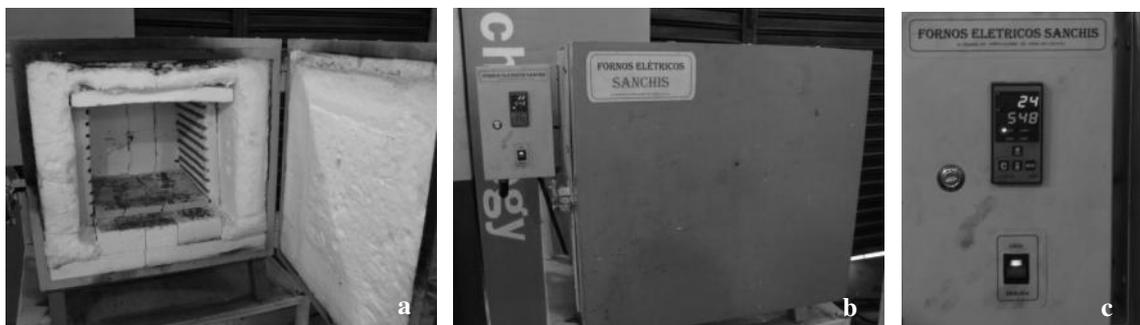
**Figura 51** - Forno para cura das resinas (a) câmara (b) vista frontal (c) painel de controle.
