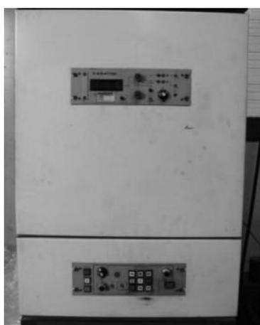
**Figura 45** – Painel de controle da prensa Kratos
