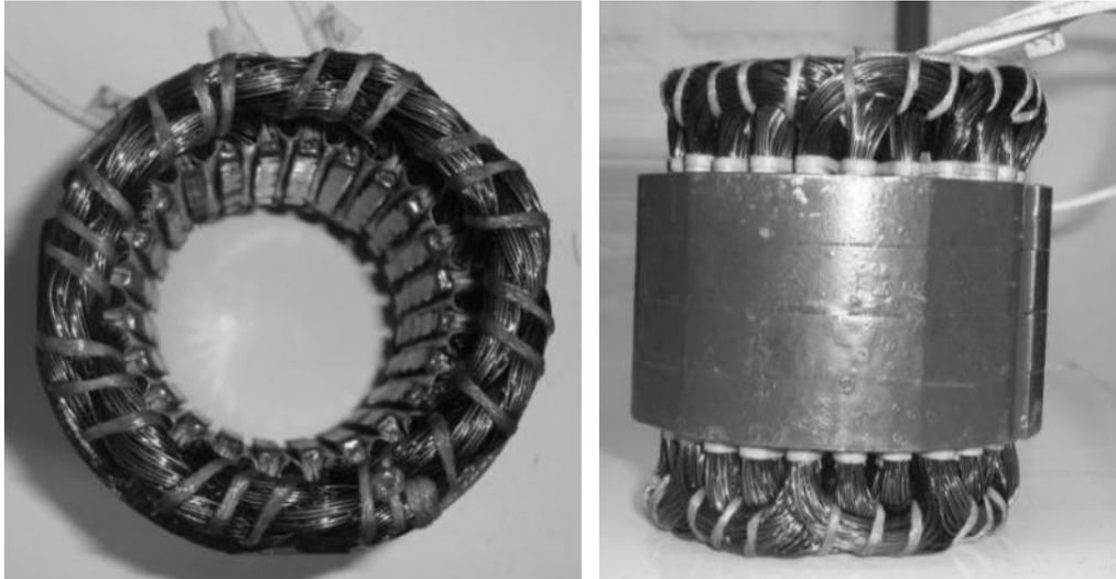
**Figura 67** – Estator bobinado.
