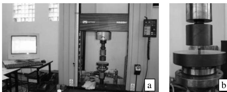
**Figura 53** – Máquina Universal de Ensaio Mecânicos INSTRON (a) Equipamento de captação de dados (b) detalhe do dispositivo de ensaios.
