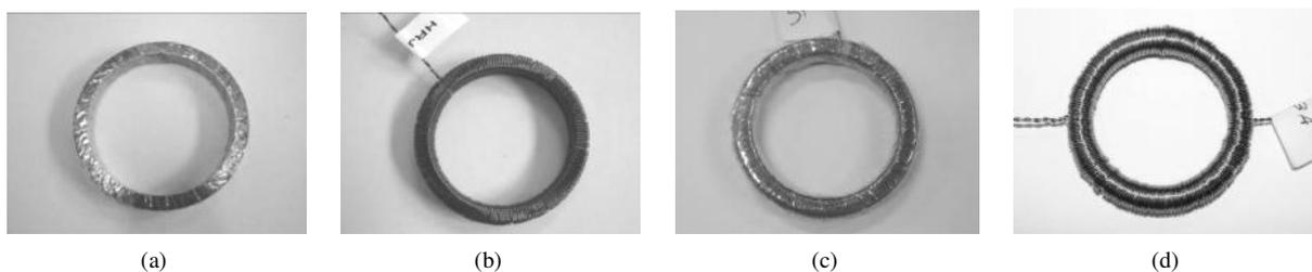
**Figura 56** - Etapas de preparação das amostras: **(a)** isolamento, **(b)** enrolamento secundário, **(c)** isolamento e **(d)** enrolamento do primário.
