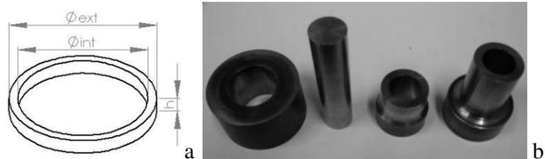
**Figura 42** – (a) corpo de prova em forma de toróide e (b) matriz para obtenção do corpo de prova.
