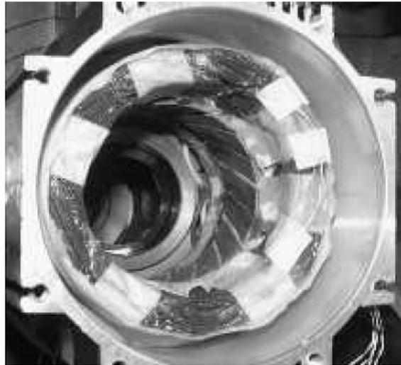
**Figura 24** – Estator de um servomotor comercial.
