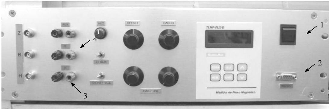
**Figura 57** - Traçador de Curvas de Histerese (TLMP-TCH-14). (1) interruptor on/off, (2) conector AC/DC, (3) conexão do enrolamento primário e (4) conexão do enrolamento secundário.
