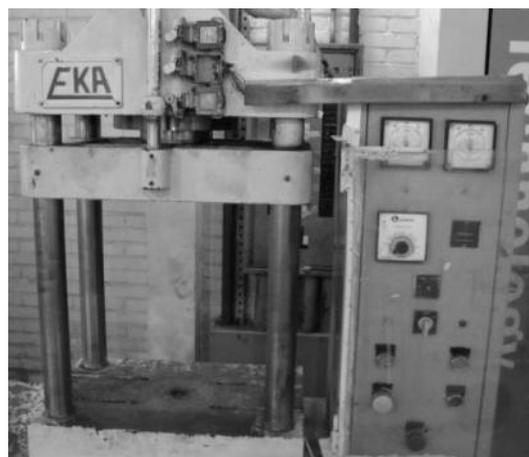
**Figura 47** – Prensa Eka utilizada na compactação dos toróides.
