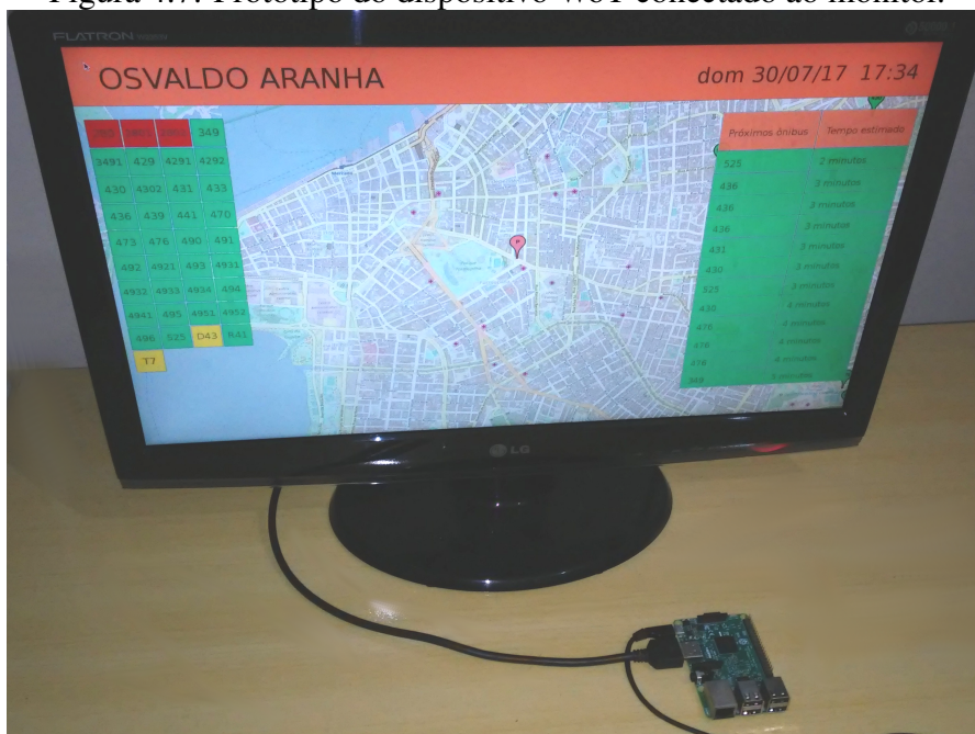
Figura 4.7: Protótipo do dispositivo WoT conectado ao monitor.
