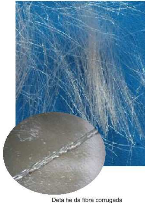
Figura 3.2: aspecto das fibras de polipropileno de 100 dtex com 50 mm de comprimento (fonte: FITESA S/A)
