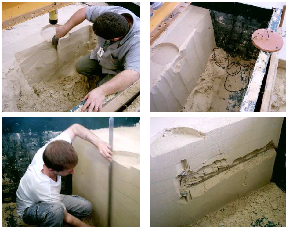
Figura 3.17: detalhes da exumação das camadas de areia
