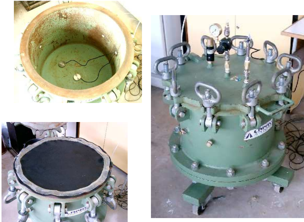
Figura 3.4: vistas da câmara de calibração grande: H/D = 0,8
