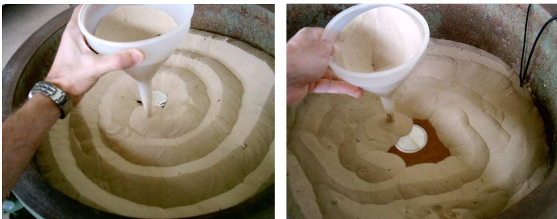
Figura 3.10: moldagem dos corpos-de-prova para calibração em areia seca
