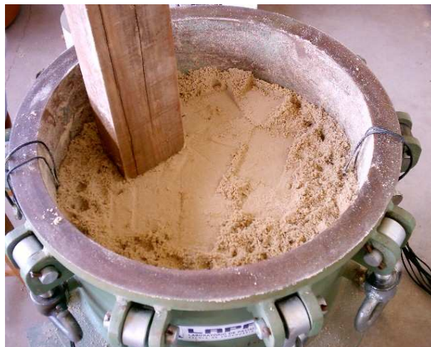
Figura 3.11: moldagem dos corpos-de-prova para calibração em areia e areia-fibra
