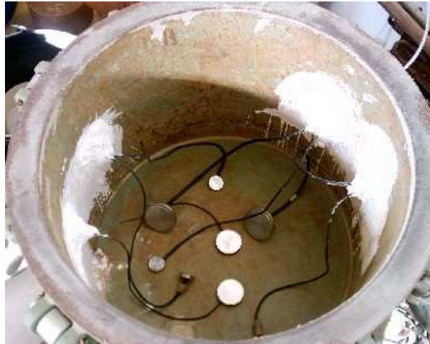
Figura 3.9: detalhe da calibração das células de tensão total em ar
