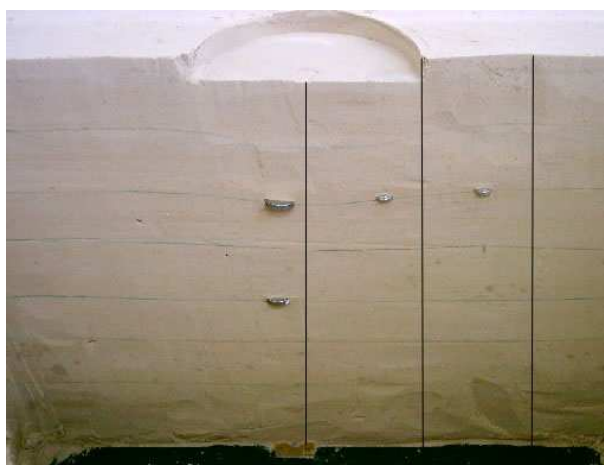
Figura 4.29: desalinhamento dos sensores no ensaio em areia sem fibras
