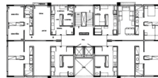
Fig. 154 Edifício Mauá – Arquiteto Eduardo de Almeida – Planta baixa do pavimento tipo.
