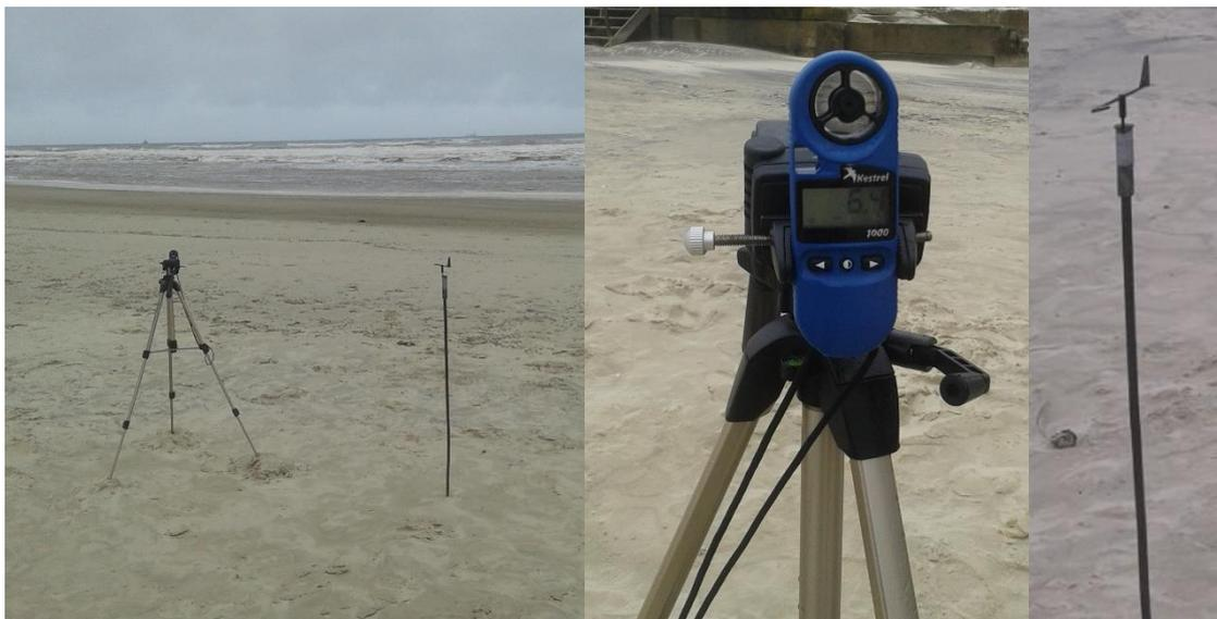
**Figura 6:** Anemômetro e seta utilizados para medição da velocidade e direção do vento, respectivamente.
