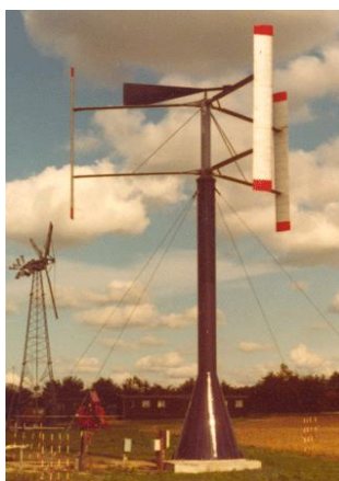
B: Turbina eólica de eixo vertical tipo Giromill.
