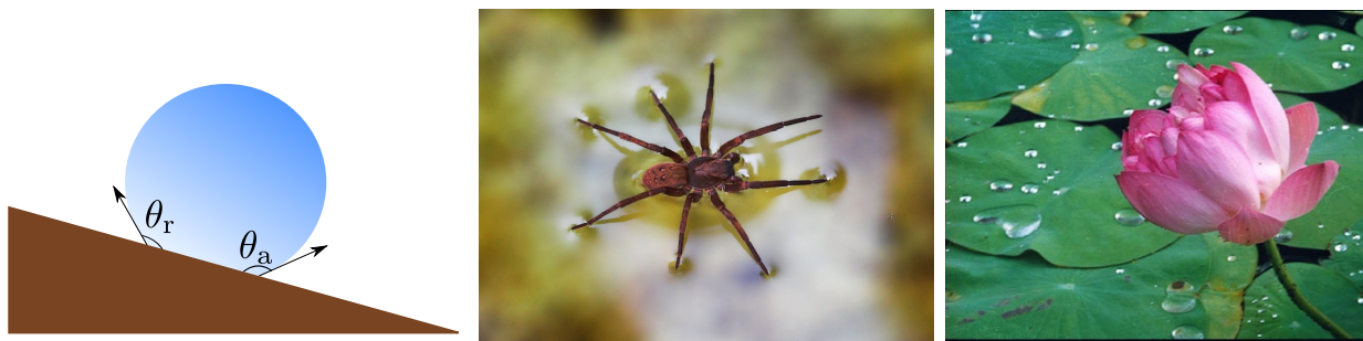
Figura 1.2: Esquerda: definição de ângulo avançado, \theta_a e ângulo retardado, \theta_r . Centro e direita: exemplos de super hidrofobia na natureza; figuras retiradas das referências [9] e [10], respectivamente.
