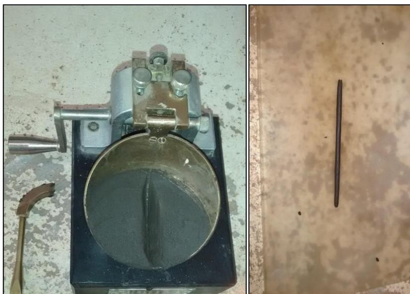
Figura 5.6. Ensaio de limite líquido e limite plástico, para a amostra de 19,0m.
