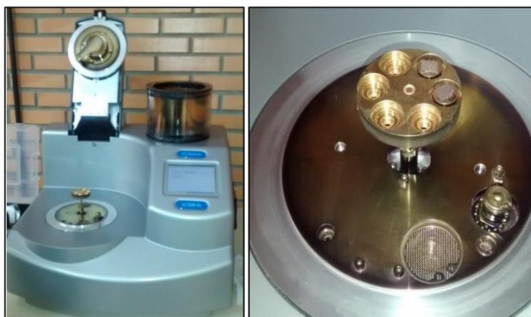
Figura 4.3. Câmara para a aplicação do material condutor.
