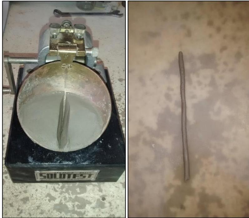
Figura 5.7. Ensaio de limite líquido e limite plástico, para a amostra de 21,0m.
