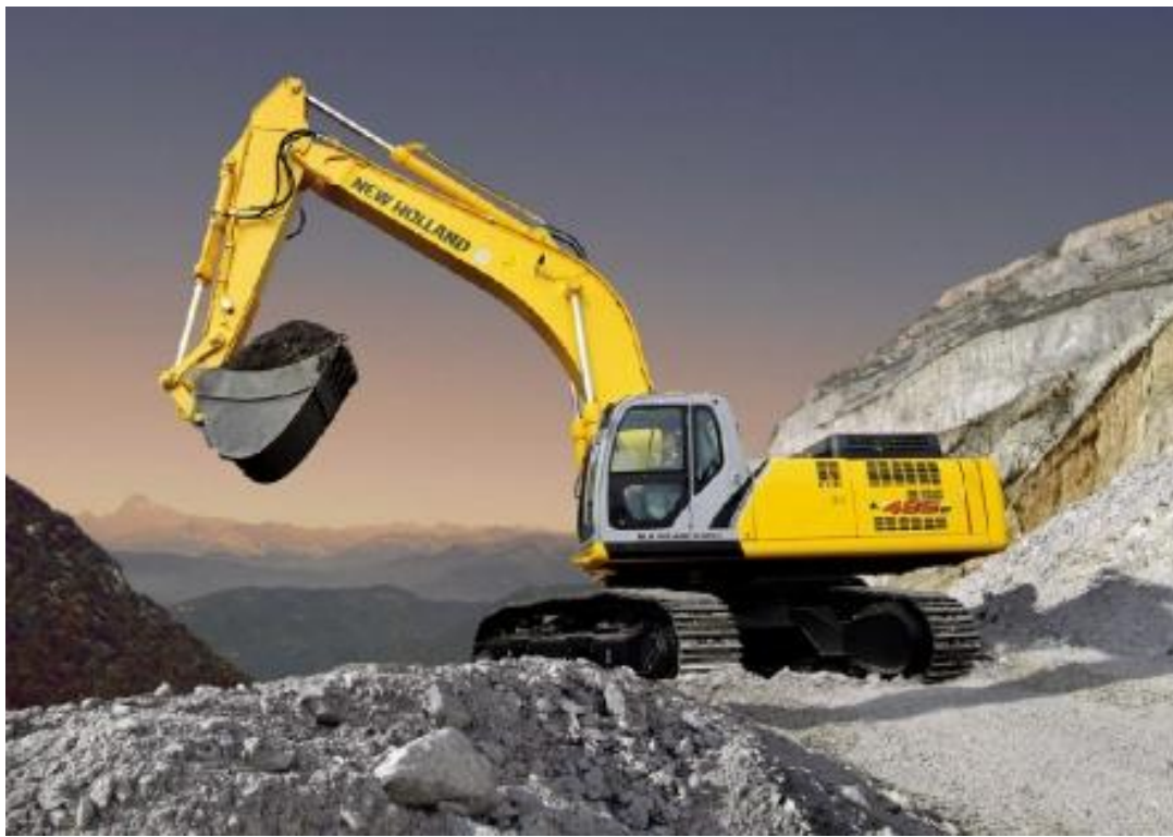
Figura 10: Exemplo de fator de enchimento da concha acima da capacidade nominal. Fonte: Komatsu (2008)
