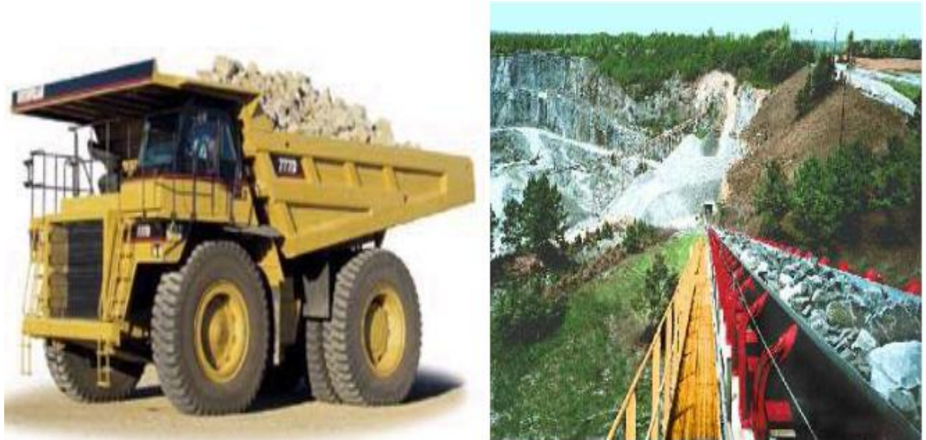
Figura 14: Sistemas de transporte. Caminhão (esquerda); Correia (direita). Fonte: Caterpillar (2009)
