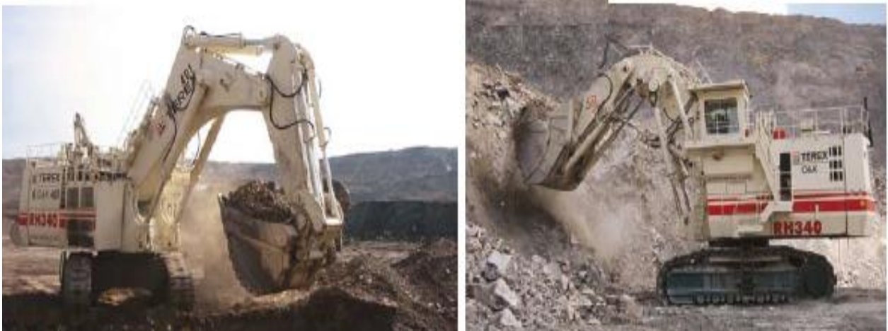
Figura 6: Escavadeiras com as duas formas de configuração da concha (retro e frontal, respetivamente). Fonte: Liebherr (2009/10)
