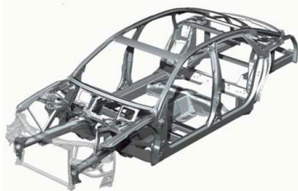
Figura 10: Estrutura tipo Spaceframe – Audi A8.
