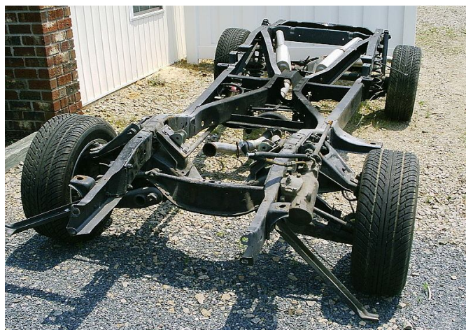
Figura 06: Chassi -longarinas paralelas de aço. Fonte: wikipedia (2008).
