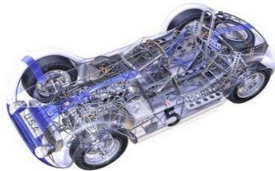
Figura 16: O mais clássico e famoso chassi tubular: Maserati Bird Cage. Fonte: wikipedia (2008).
