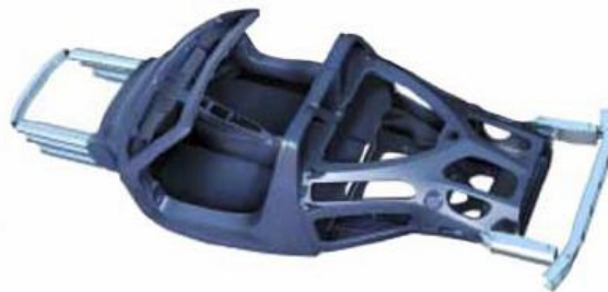
Figura 11: Estrutura em compósito (fibra de carbono) – Porsche Carrera GT.
