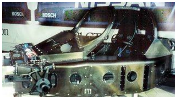
Figura 12: Chassi misto fibra de carbono e honey comb Nissan P35 1993.
