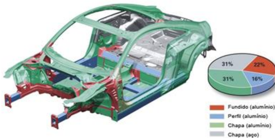
Figura 02: Tipos de Aplicação do alumínio no Audi TT.
