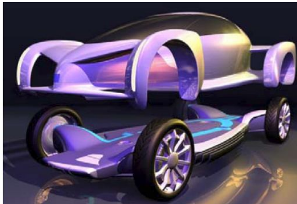
Figura 07: Estrutura do chassi tipo skate – GM. Fonte: Gonçalves e Ferreira (2005).
