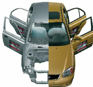
Figura 08: Estrutura Monobloco – Hyundai Accent. Fonte: Gonçalves e Ferreira (2005).
