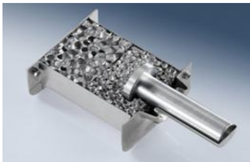
Figura 140: Exemplos de modos de dissipação da energia de impacto frontal na estrutura do veículo – crash box .
