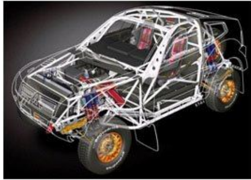
Figura 15: Mitsubishi Pajero Evolution IV 2007 – Chassi tubular. Fonte: wikipedia (2008).
