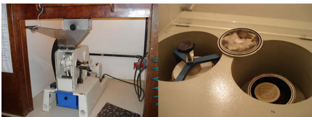
Figura 15: À esquerda britador; à direita moinho de discos orbitais.
