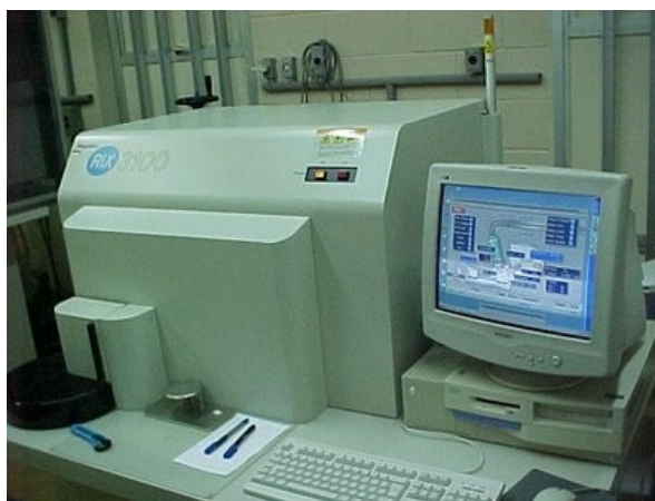
Figura 17: Equipamento para leitura e interpretação dos dados na técnica de fluorescência de raios X.
