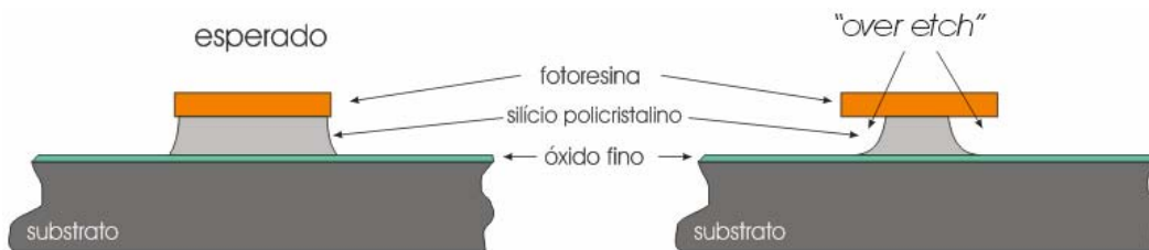
Fig. 5.10 – Estrutura esperada após ataque do silício policristalino e estrutura com overetch .
