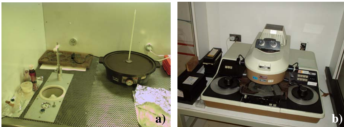
Fig. 2.6 – (a) Spinner para deposição de fotoresina e (b) fotoalinhadora
