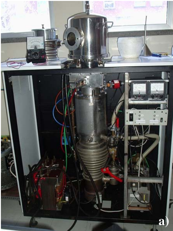
Fig. 2.3 – (a)Evaporadora de metais e (b)forno de deposição de silício policristalino.
