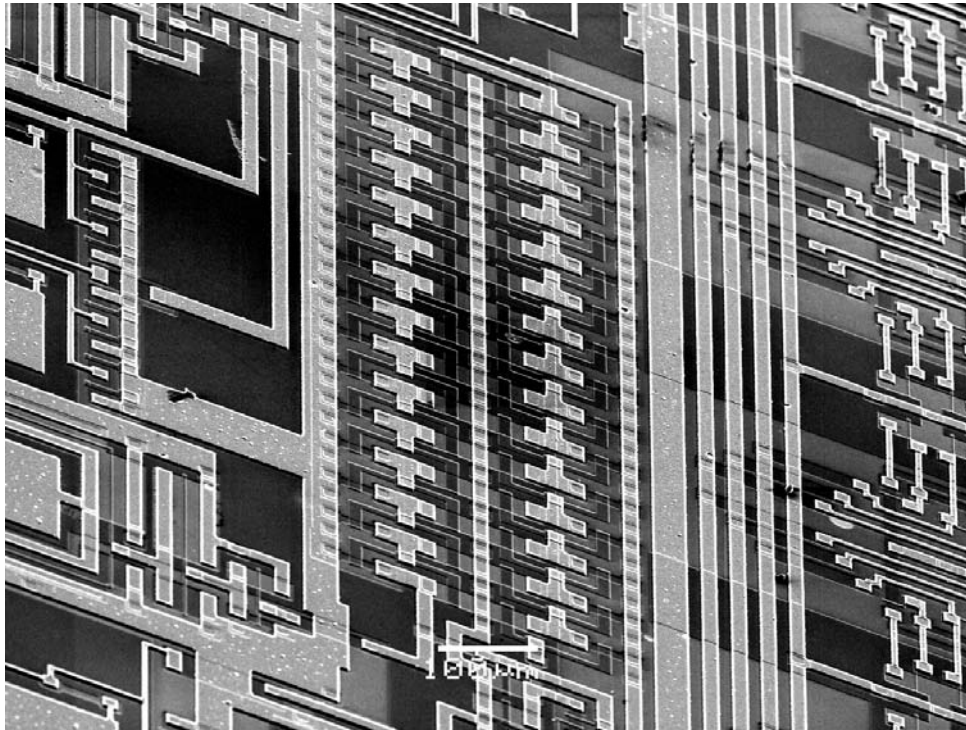
Fig. 6.16 – Imagem do oscilador em anel obtida por microscopia eletrônica de varredura.
