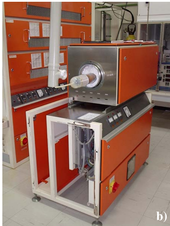
Fig. 2.3 – (a)Evaporadora de metais e (b)forno de deposição de silício policristalino.
