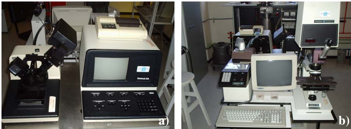
Fig. 2.8 – (a) Perfilômetro Dektak IIa e (b) medidor de espessuras NanoSpec.
