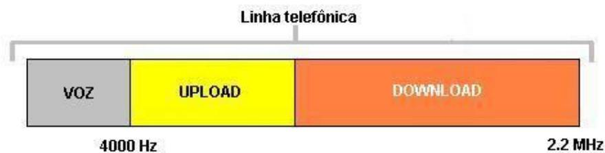
Figura 2.1: Espectro utilizado pelo ADSL
