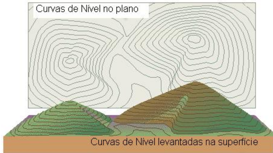
Figura 8 - Representando curvas de nível no plano e na superfície montanhosa, Fonte: adaptado de < http://w3.cnice.mec.es/eos/MaterialesEducativos/mem2000/arqueologia/Curvas_Nivel.gif > acesso em:31/03/2008.
