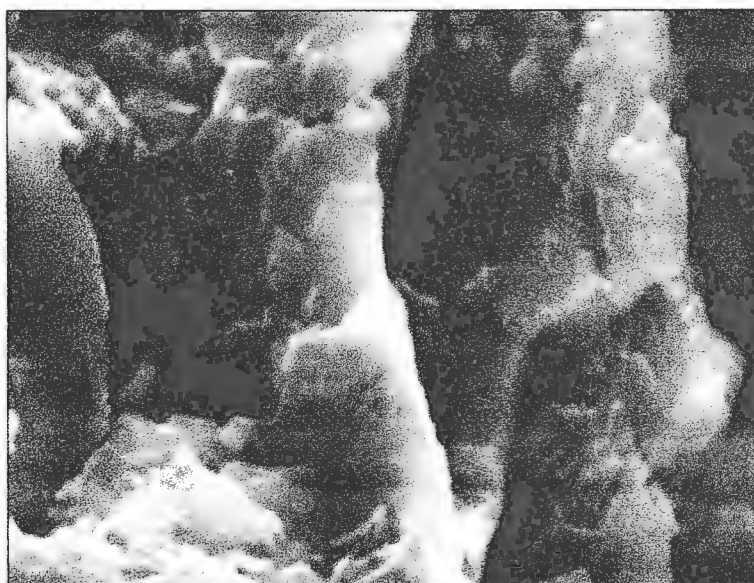
Figura 4.2 – Detalhe da porosidade do monolito cerâmico de cordierita
