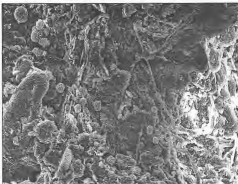
Figura 4.11 – Superfície do monolito impregnado com cobre
