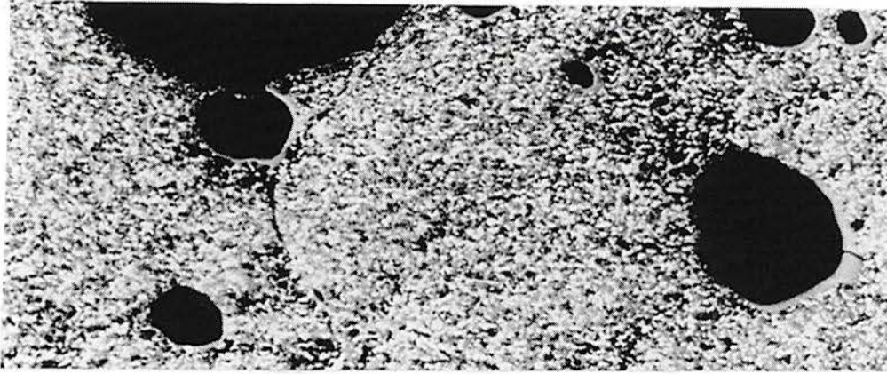
Figura 6.5 - Micrografia após a sinterização. Sem ataque, 50X
