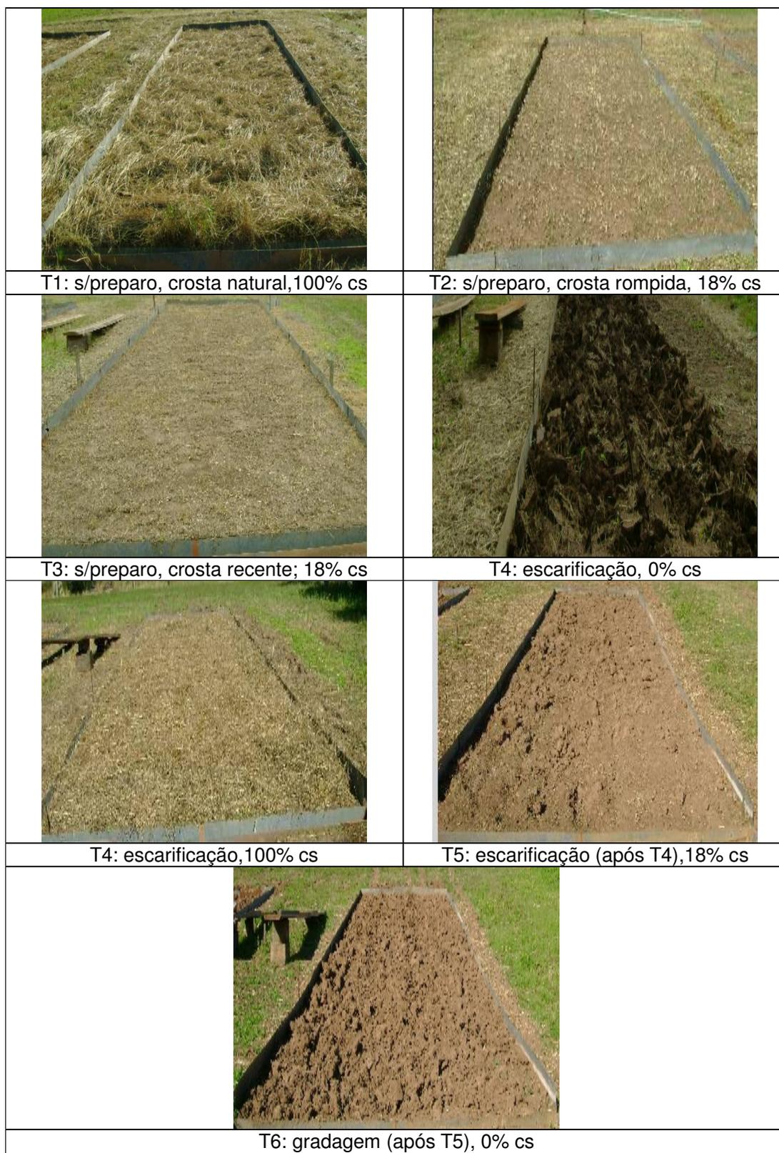
FIGURA 3. Vista da superfície do solo nas parcelas experimentais logo após a construção da condição básica de estudo em cada teste de erosão com chuva simulada (T1 a T6), porém antes da sua realização (obs: a superfície de solo escarificada e com 0% de cobertura superficial – cs – mostrada acima não recebeu chuva simulada, constando na figura apenas para fins de ilustração).
