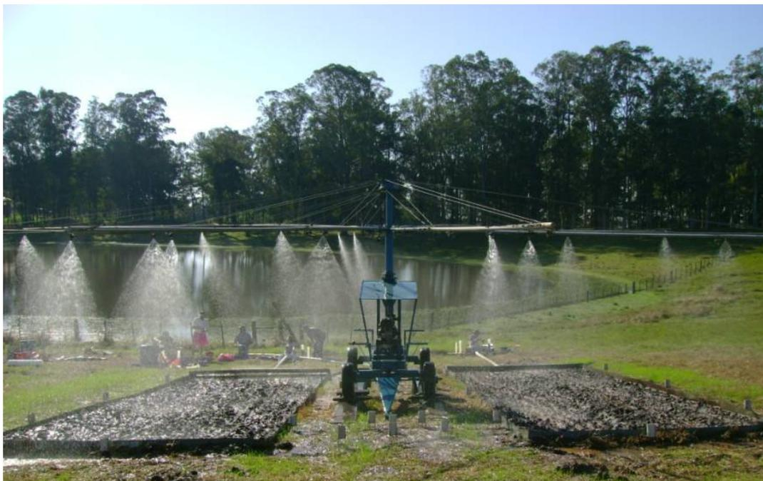
FIGURA 2. Aparelho simulador de chuva utilizado no estudo (tipo de braços rotativos ou modelo Swanson), simultaneamente operando sobre um par de unidades experimentais ou parcelas de erosão.
