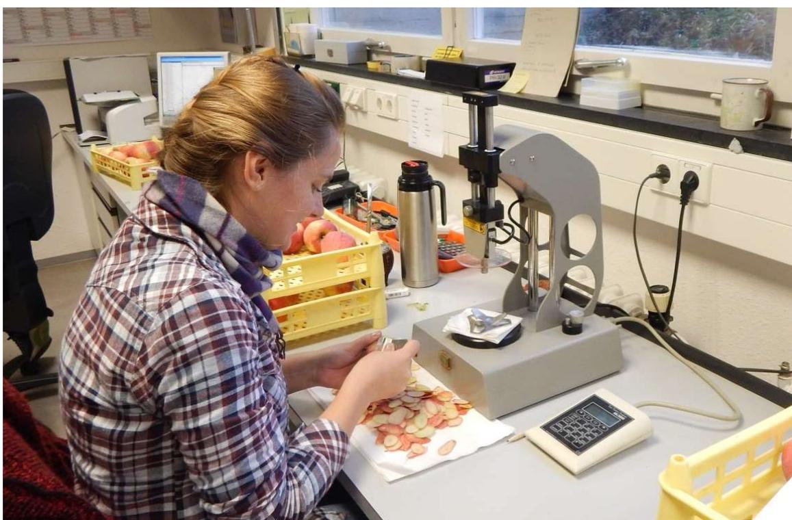
*Figura 2. Uso de penetrômetro de bancada para determinar firmeza de polpa de maçãs em laboratório.
