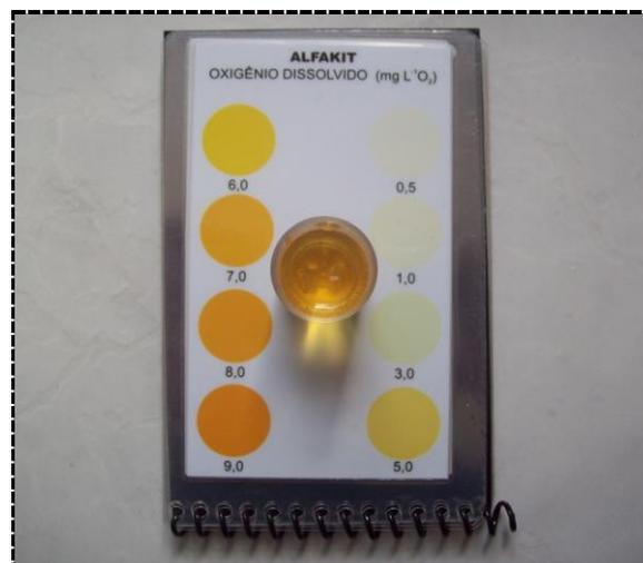
Figura 08: Análise colorimétrica do oxigênio dissolvido.
