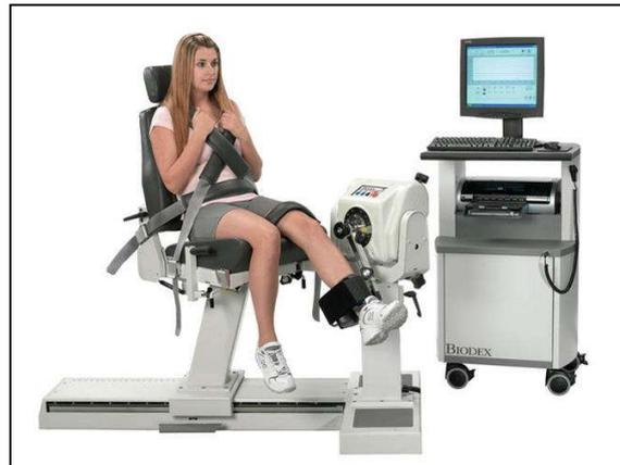
Figura 5: Posicionamento do sujeito no dinamômetro isocinético (Fonte: <http://www.biodex.com/>).
