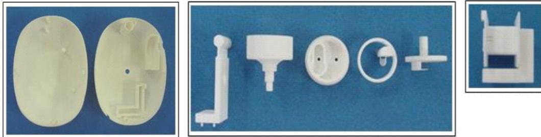
Figura 27 – Compressor prototipado
