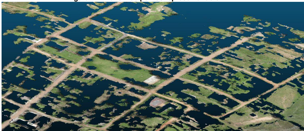
Figura 22 - Nuvem de pontos representando o MDT
