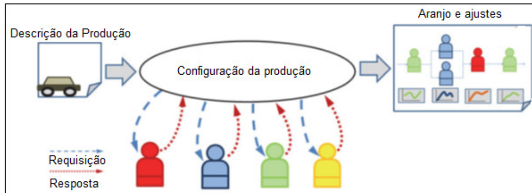
Figura 36 Modelo de configuração dos agentes para formar um arranjo produtivo.
