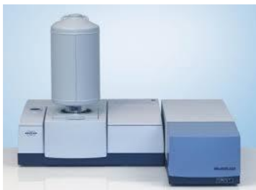
Figura 19: Bruker MultiRAM, equipamento utilizado para realizar as medidas de espectroscopia Raman.
