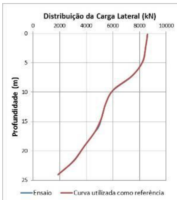
Figura 5.18: Curva carga-profundidade obtida em campo e a curva aproximada para os pontos de 0, 2,4, 4,8, 7,2, 9,6, 12,0, 14,4, 16,8, 19,2, 21,6 e 24,0m de profundidade
