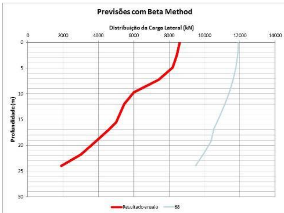
Figura 4.20: Previsões da curva carga-profundidade realizadas com uso do Beta Method
