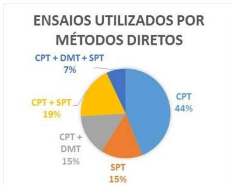
Figura 4.5: Ensaios utilizados nas previsões por métodos diretos
