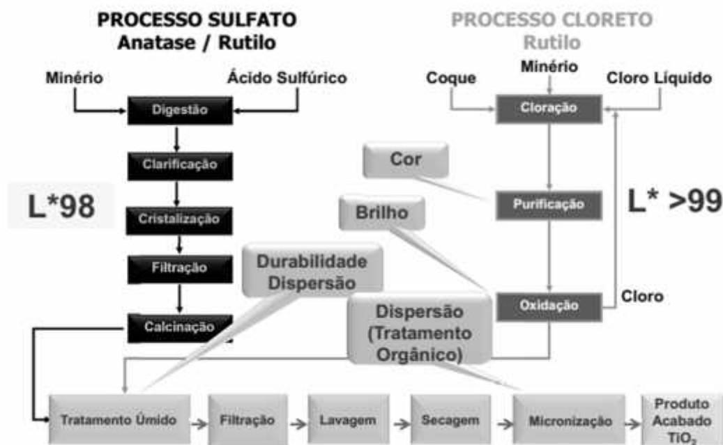
Figura 13. Processo de produção do TiO 2 comercial.
