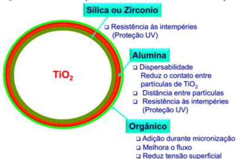
Figura 14. Tratamentos superficiais dos \text{TiO}_2 R902 e R706 fornecidos pela DuPont
