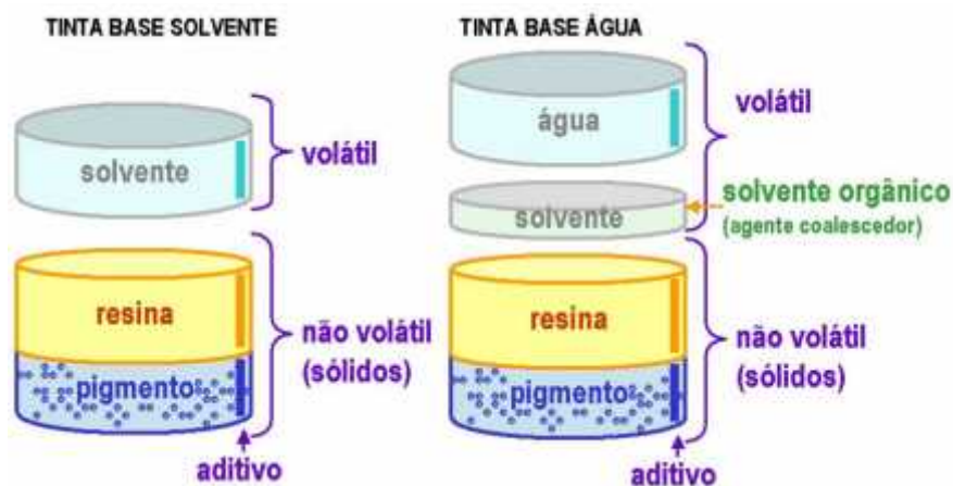
Figura 20. Exemplo de composição básica de tintas à base solvente e base água
