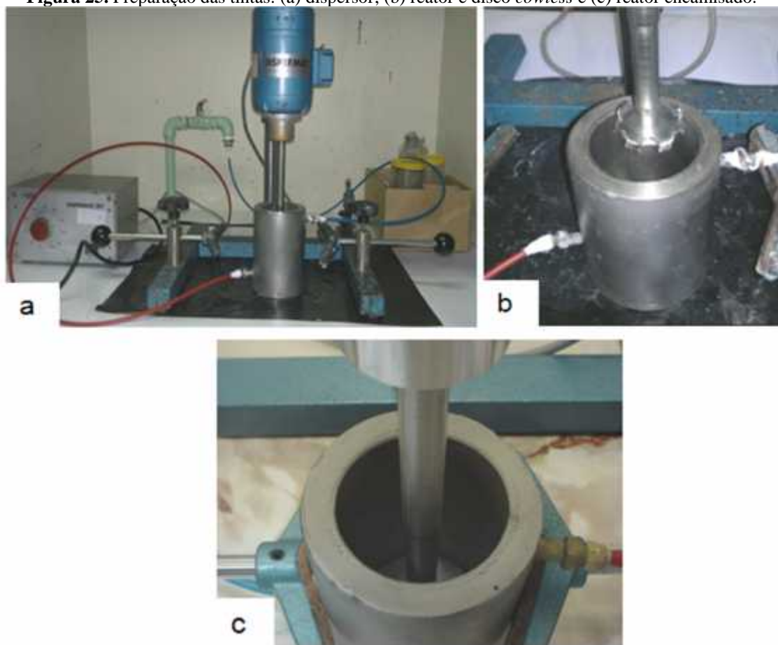
Figura 25. Preparação das tintas: (a) dispersor; (b) reator e disco cowless e (c) reator encamisado.
