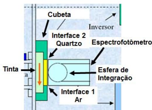
**Figura 6.3 – Detalhe da Colorcélula, ilustrando a Cubeta e o espectrofotômetro.**
