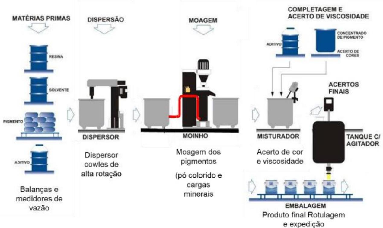
**Figura 5.15 Processo de Fabricação de Tintas**
