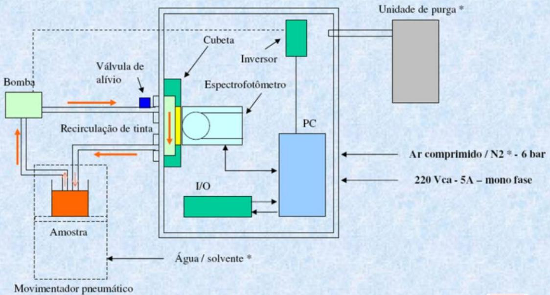
Configuração típica para Colorcélula de laboratório.
