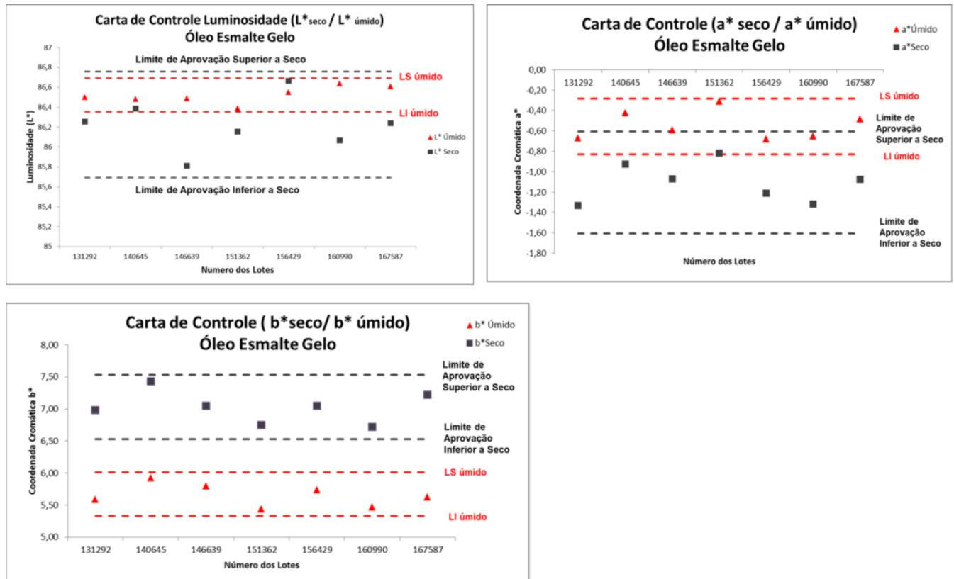
**Figura 6.11 - Cartas de Controle das Coordenadas Cromáticas da Cor Gelo – Nestes gráficos são plotadas os valores absolutos das coordenadas cromáticas  $L^*$ ,  $a^*$  e  $b^*$  tanto a seco quanto a úmido. As linhas pontilhadas representam o limite superior e o limite inferior de controle.**
