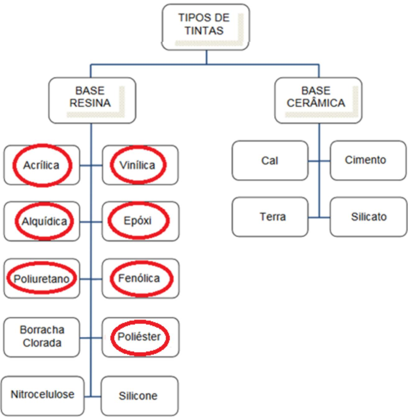
**Figura 5.14 - Classificação das Resinas – Com um circulo vermelho são identificadas as resinas de maior aplicabilidade.**
