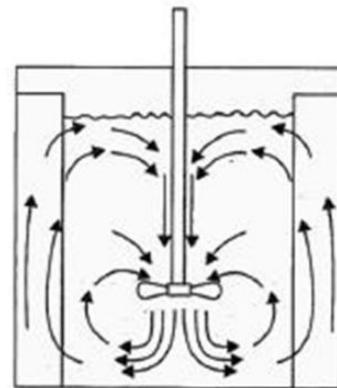
Sistema Turbulento de Agitação
