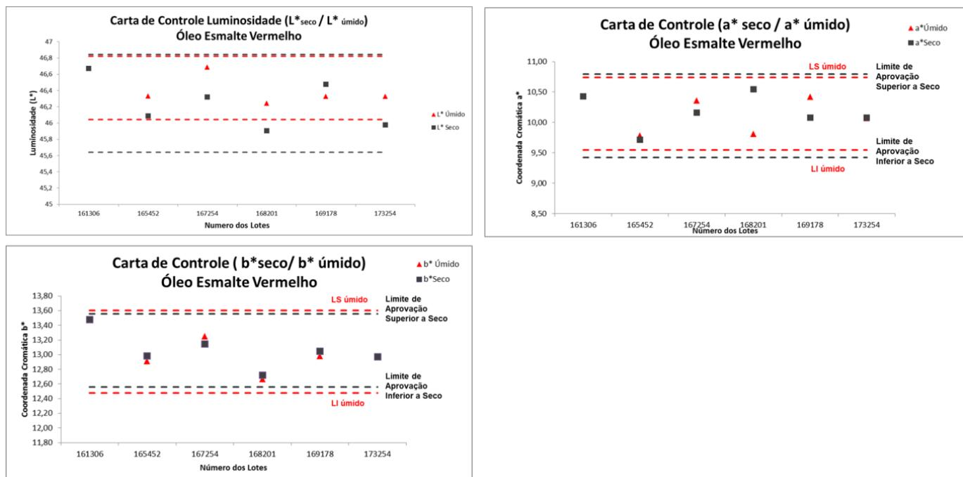
**Figura 6.15 - Cartas de Controle das Coordenadas Cromáticas da Cor Vermelha - Nestes gráficos são plotadas os valores absolutos das coordenadas cromáticas L\*, a\* e b\* tanto a seco quanto a úmido. As linhas pontilhadas representam o limite superior e o limite inferior de controle.**
