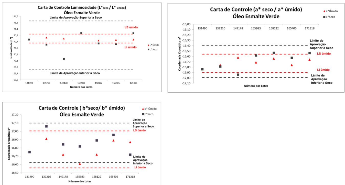
**Figura 6.12 - Cartas de Controle das Coordenadas Cromáticas da Cor Verde -** Nestes gráficos são plotadas os valores absolutos das coordenadas cromáticas  $L^*$ ,  $a^*$  e  $b^*$  tanto a seco quanto a úmido. As linhas pontilhadas representam o limite superior e o limite inferior de controle.
