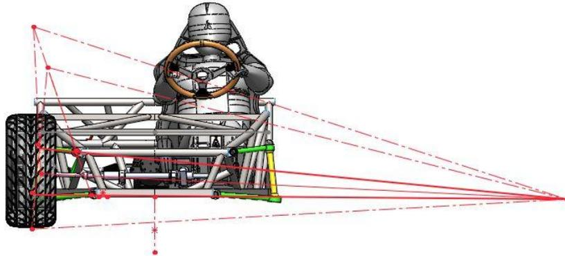
A geometria da suspensão traseira foi determinada de forma que o centro de rolagem da carroceria fique mais elevado do que o da dianteira. Como o veículo possui o centro de gravidade deslocado para a dianteira, seu comportamento é subdirecional, ou seja, o eixo dianteiro tende a derivar em curvas.
