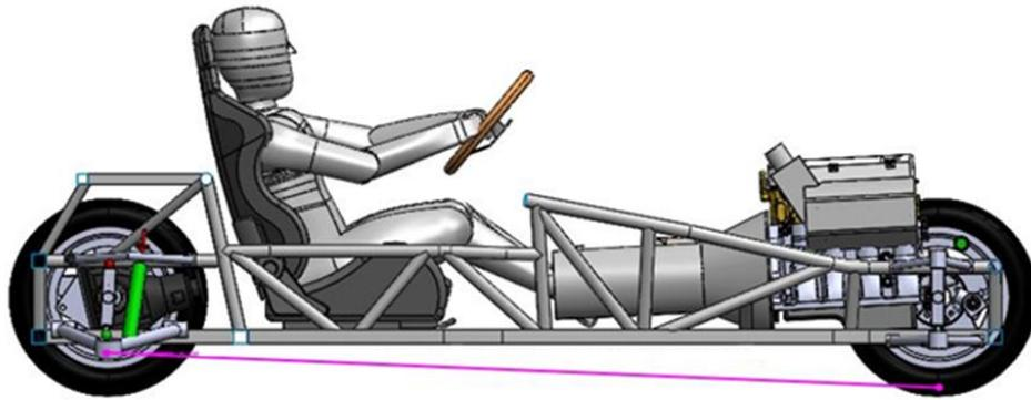
Simulando o movimento da roda se deslocando em relação a carroceria pode-se constatar que o sistema de direção está projetado de forma adequada, já que a variação de ângulo de câmber atendeu aos parâmetros preestabelecidos (figura 4 e 5).
