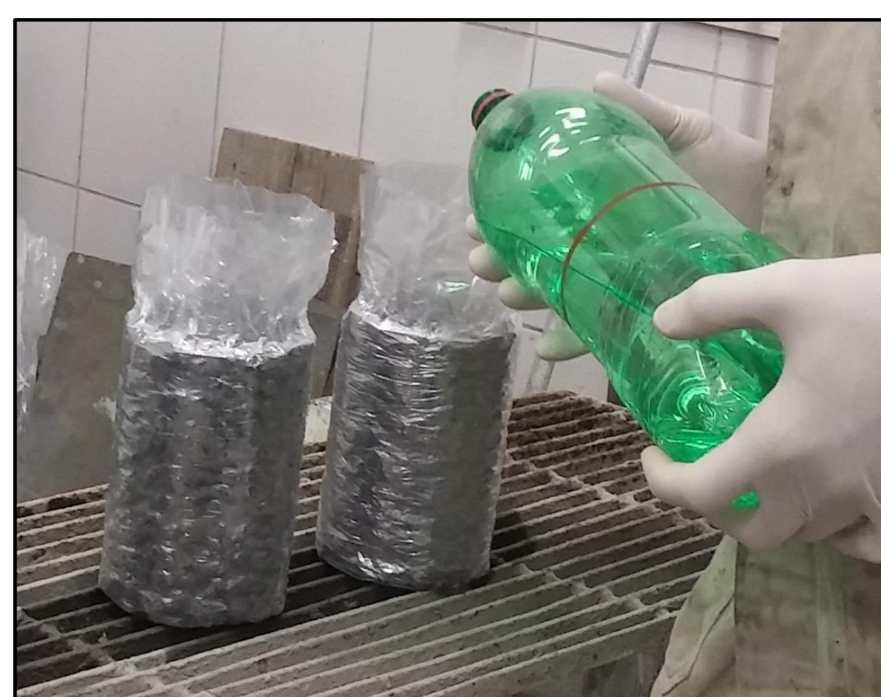
Ensaio de infiltração
