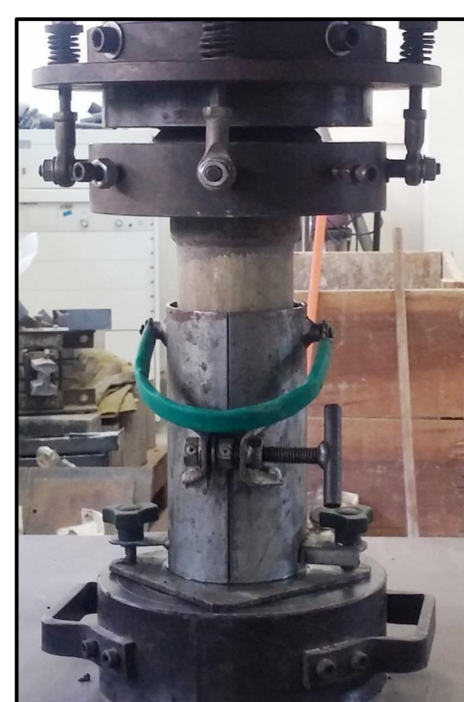
Aplicação da carga para compactação
