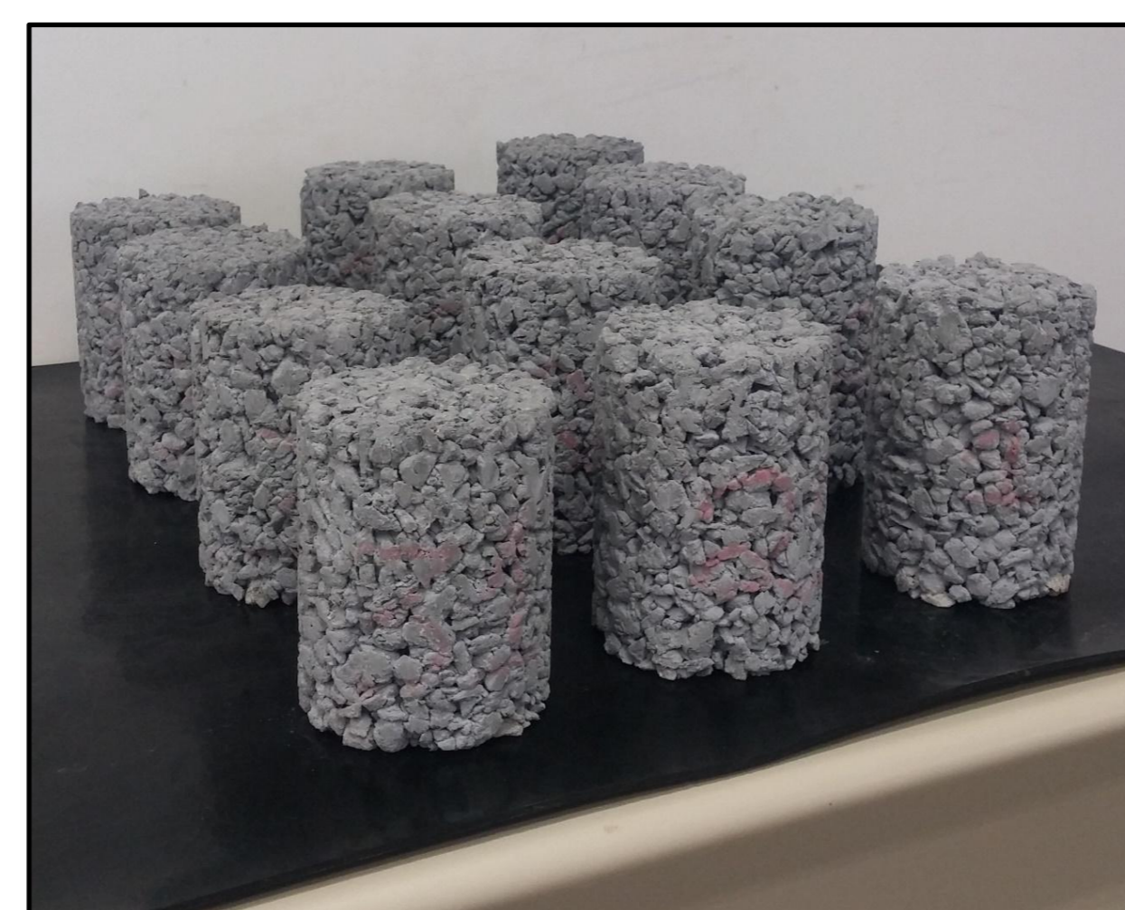
Corpos de prova com alturas distintas devido às diferentes cargas aplicadas
