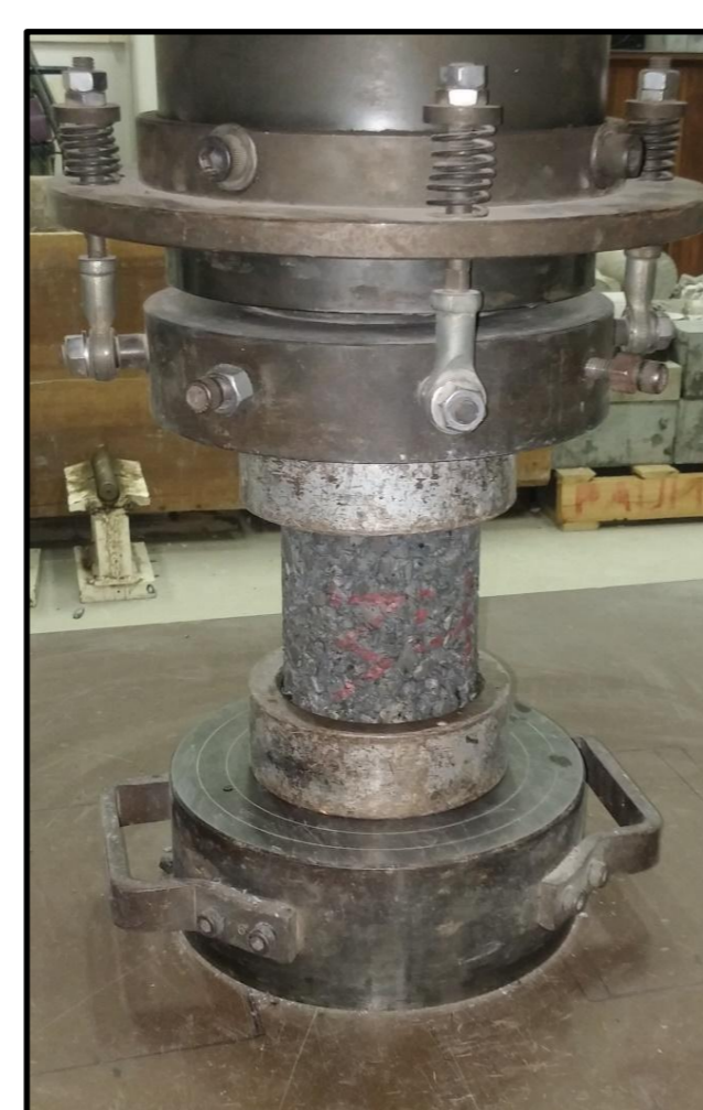
Ensaio de resistência à compressão axial
