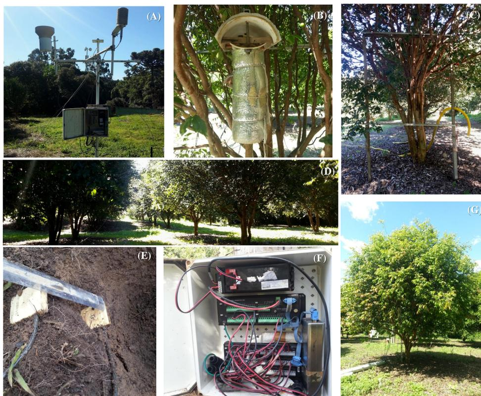
**Figura 1.** EMA (A), psicrômetro (B), sensores de RFA (C), panorâmica do pomar (D) sensores TDR para umidade do solo (E) e sistema *datalogger* (F), em pomar de jabuticabeiras (G). Porto Alegre, RS. 2016.
