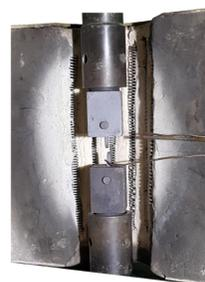
Figura 3 – Seção do forno elétrico
