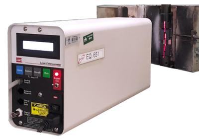
Figura 4 – Extensômetro Laser
