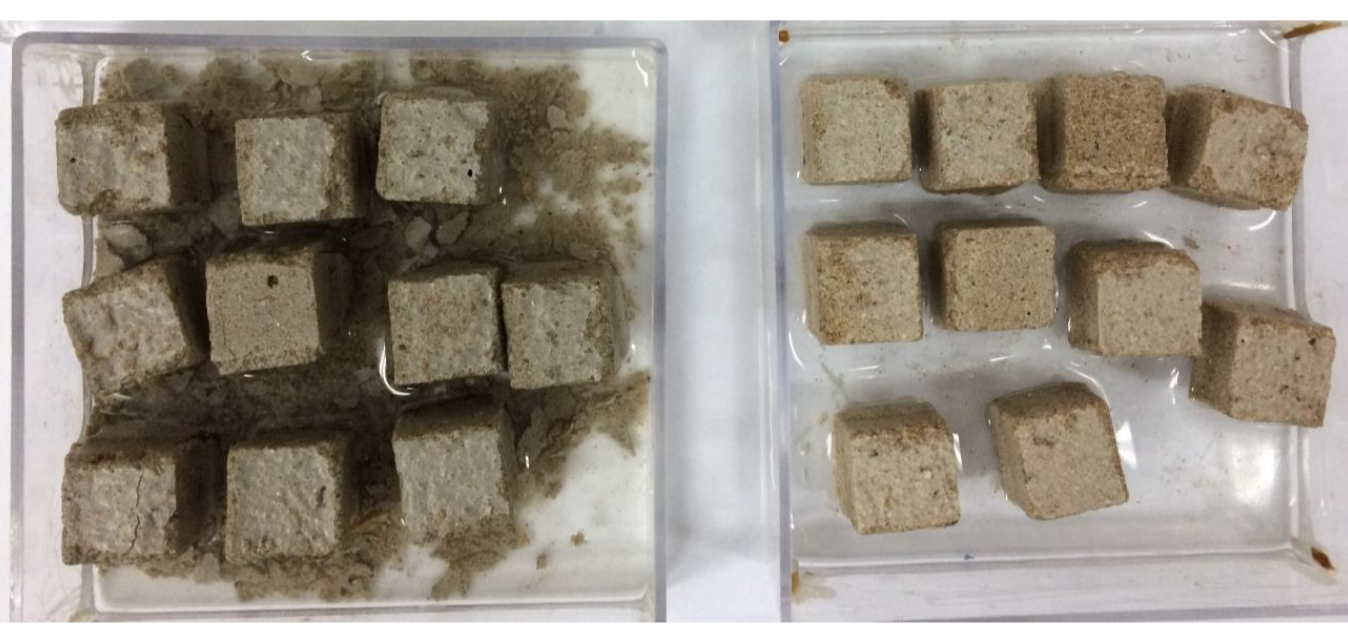
Figura 2 – Impregnação das amostras em solução de NaCl 3% em água deionizada: (a) argamassa mista, (b) argamassa simples
