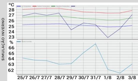
■ T. Radiante ■ T. de operação ■ T. do ar ■ T. interna ■ Umidade relativa
