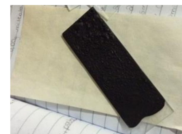
Figura 5. Amostra sobre placa de vidro para análise de DRX.
