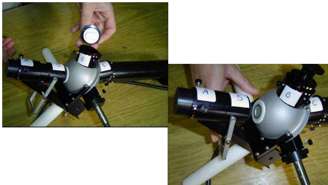
FIGURA 10. Funcionamento da esfera integradora do espectrorradiômetro LI-1800.
