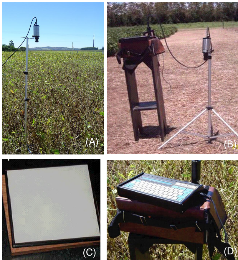
Figura 12. Determinações de campo. Medições da radiação no dossel de soja (A) e do solo coberto com palha (B), placa de referência (C) e teclado para operação do sistema (D). Eldorado do Sul, RS, 2003/04.
