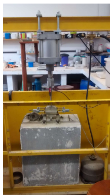
Equipamento responsável por realizar ensaios de carregamento cíclico para encontrar a vida de fadiga de uma amostra.
