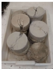
Corpos de prova rompidos.
