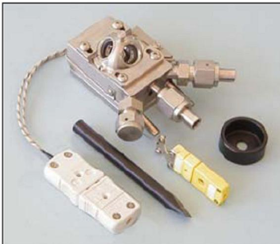
**Figura 30.** Célula de DRIFT, utilizada em todos os experimentos de adsorção de monóxido bem como nas reações de FT.
