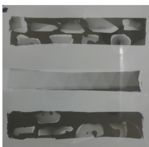
Figura 1. Lâmina de microradiografia transversal para visualização em microscópio e análise por software
