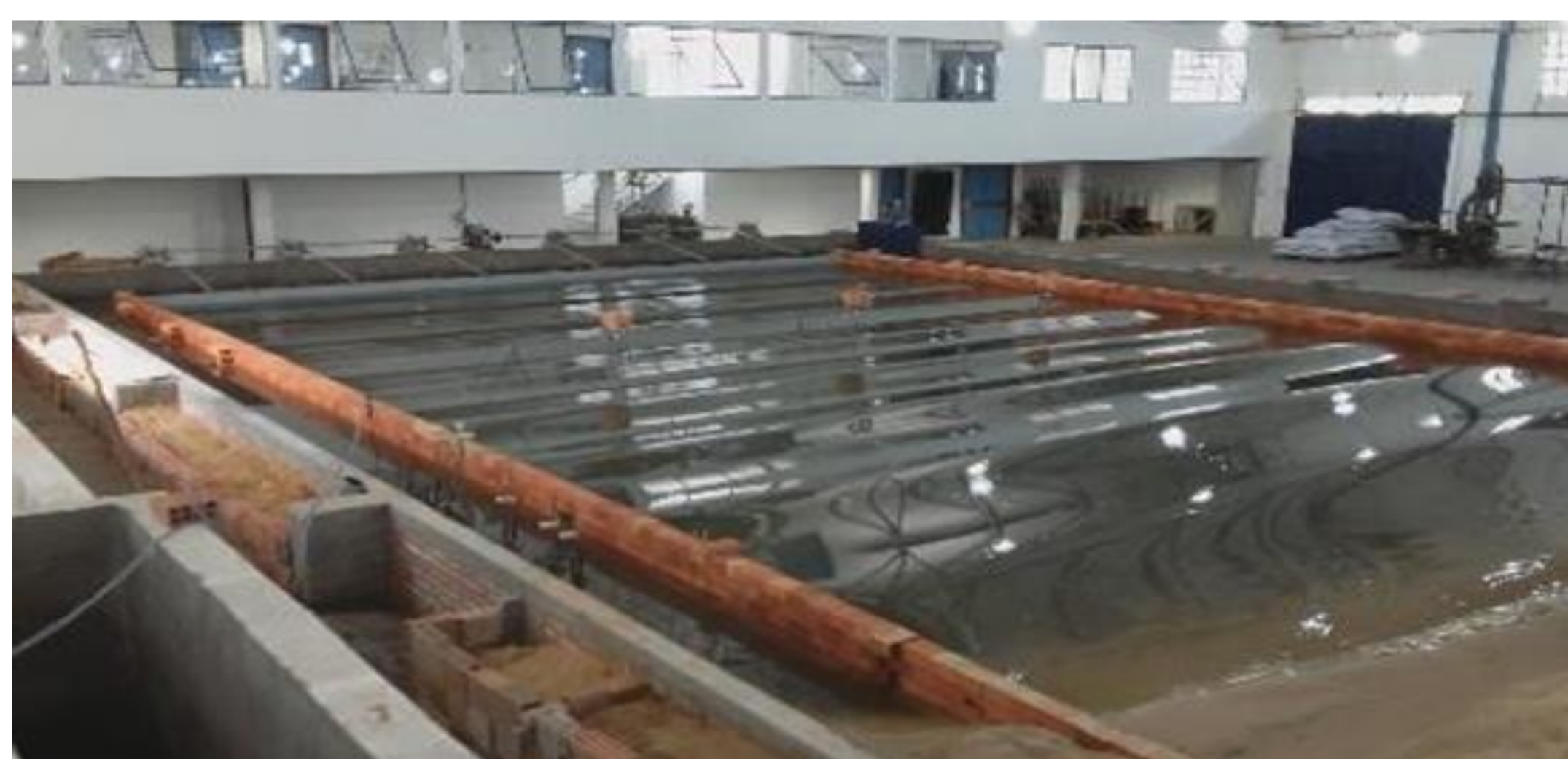
Figura 2 – Tanque de ondas em funcionamento com as sondas capacitivas posicionadas.
