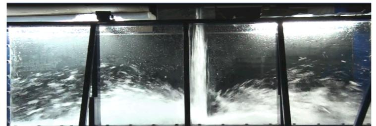
Figura 4 - Imagem do jato incidindo perpendicularmente ao fundo do canal.
