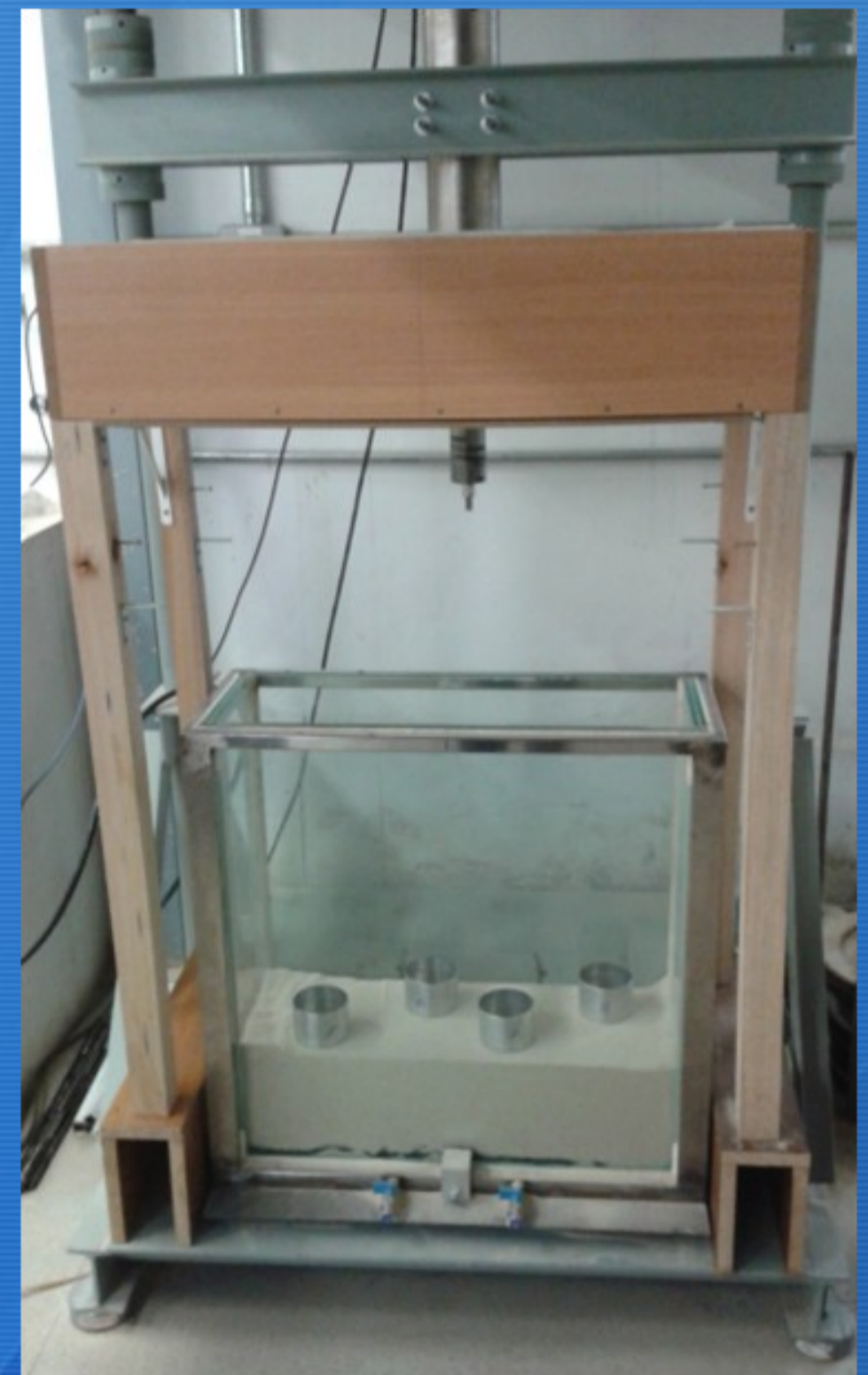
Equipamento utilizado para ensaio. Na imagem, um ensaio de densidade da areia era preparado para atestar a homogeneidade da mesma, feito em três camadas.
